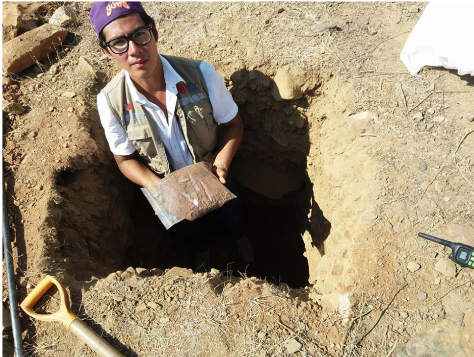
Extracción de las muestras de suelos en centro poblado de Panamá. Foto N°01
