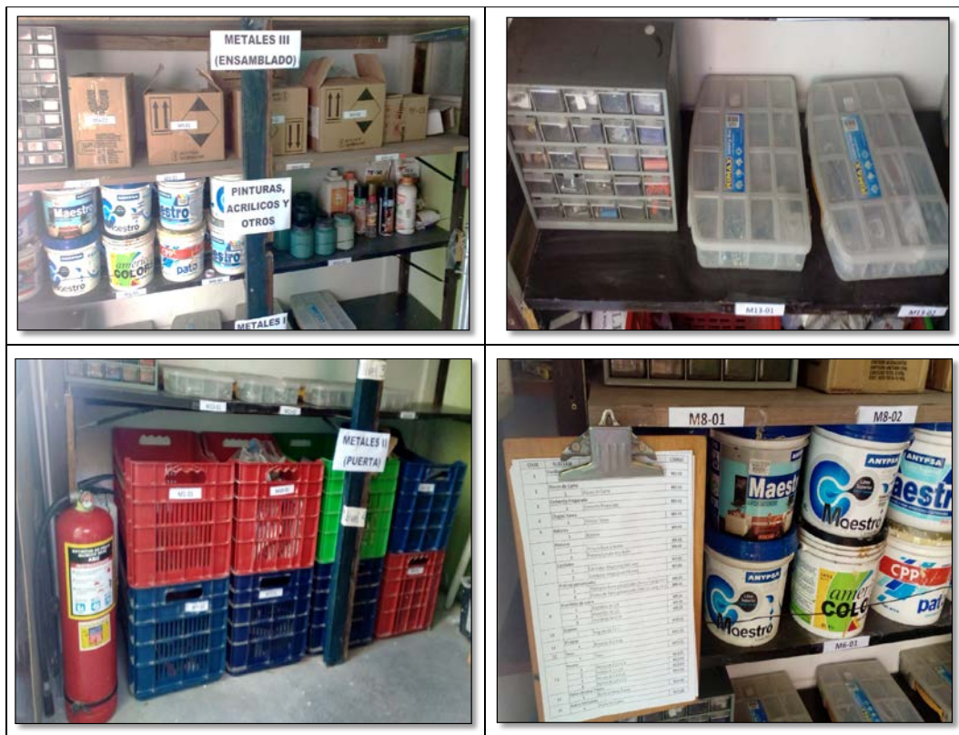
Figura 47. Aplicación del seiton en el área del almacén de la empresa SERTES S.A.C
