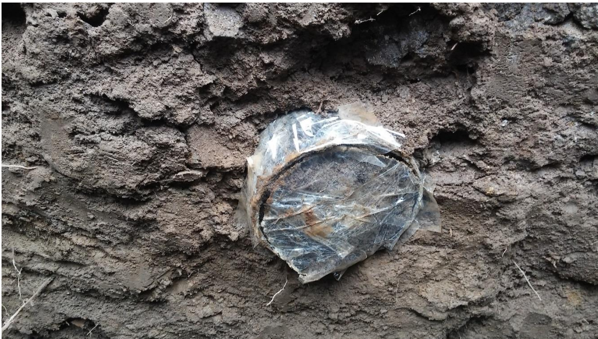
ANEXO N°7: EXTRAYENDO LA MUESTRA PARA LA CAPACIDAD PORTANTE DEL RESERVORIO.
