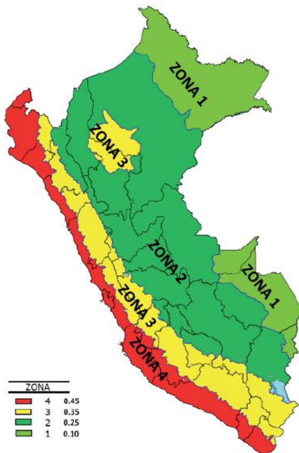
Figura N° 01: Zonificación de las zonas sísmicas
