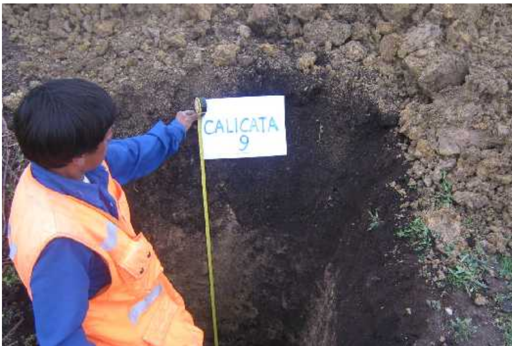
FOTO N° 08: MEDDA DE PROFUNDIDAD DE CALICATA
