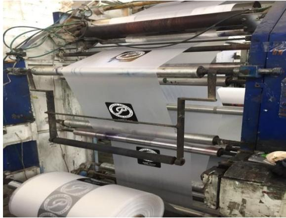
Máquina flexográfica, donde se utiliza las tintas, solventes y clises.
