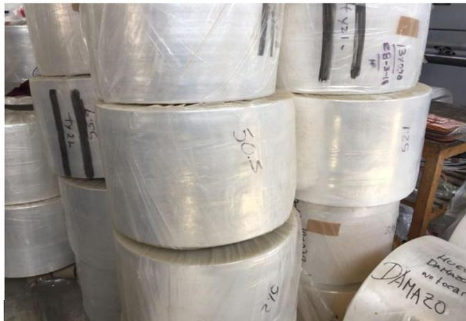
Bobinas de plástico, de aproximado de 50 kg que demora 2h de producirse
