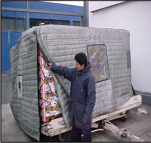
Control de temperatura con mantas térmicas (Foto: Frío Aéreo)
