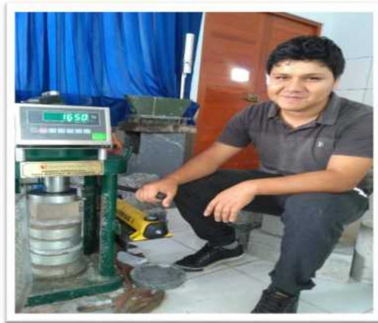
Figura N° 18: Ensayo a la compresión del adobe con 1.0 %
