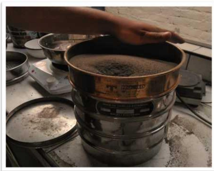
Figura N° 06: Tamices sometidos a agitadas para lograr pasar el material de acuerdo a sus dimensiones
