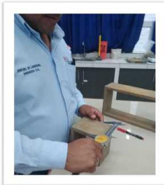
Figura N° 26: Midiendo con la ayuda de un vernier el molde de los cubos de adobe.
