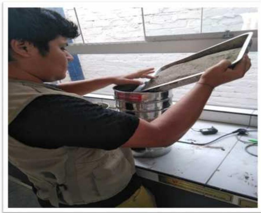
Figura N° 05: Muestra obtenida de la cantera “La Llave”, sometido al ensayo granulométrico, a través de tamizado
