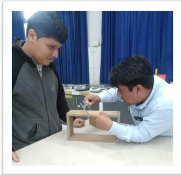
Figura N° 25: Midiendo con la ayuda de un vernier el molde del adobe.
