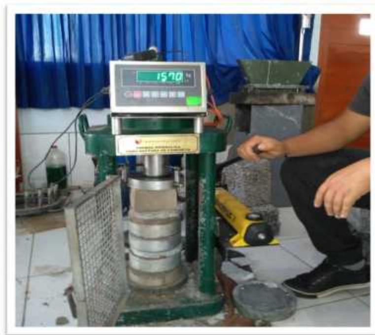
Figura N° 17: Ensayo a la compresión del adobe estabilizado con 0.5% (periodo de 7 días)
