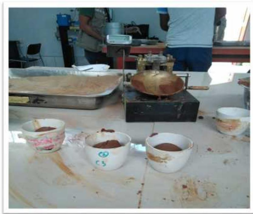
Figura N° 10: colocación de la muestra en las taras.
