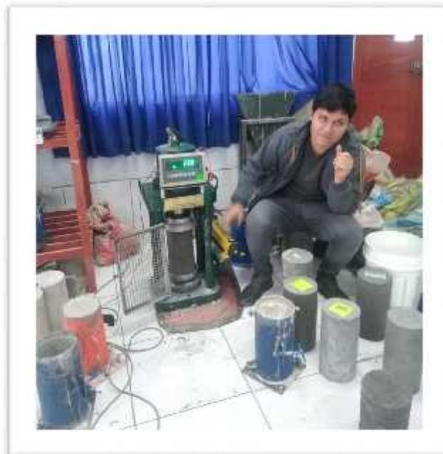
Figura N° 23: Ensayo a tracción de adobes cilíndricos
