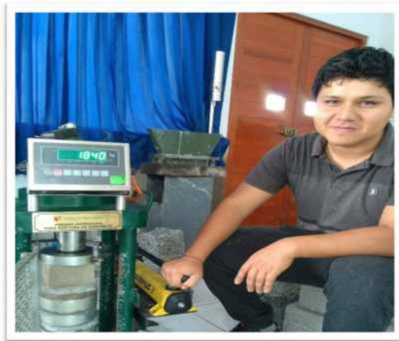
Figura N° 21: Ensayo a la compresión del adobe estabilizado con 2.0%
