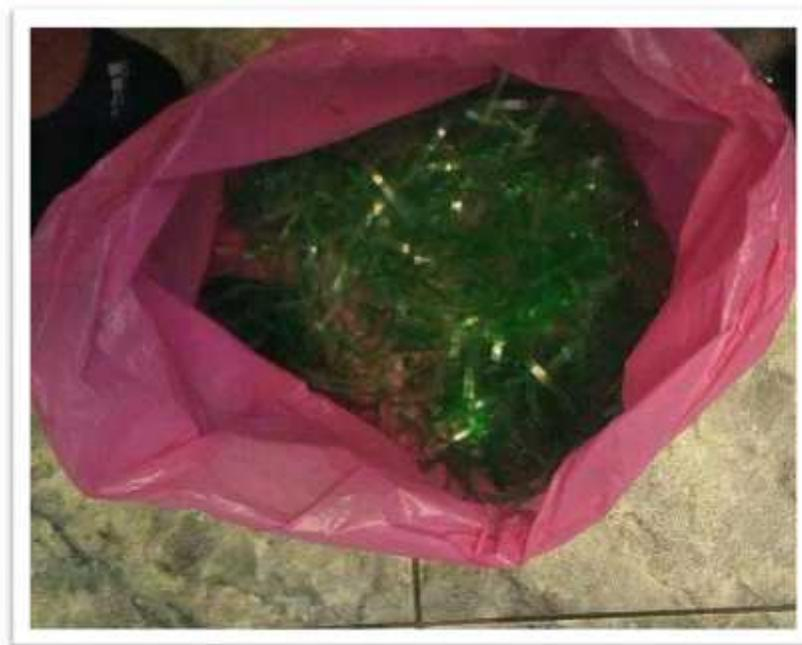
Figura N° 13: Recorte de las botellas recicladas en fibras (fibras de tereftalato de polietileno)
