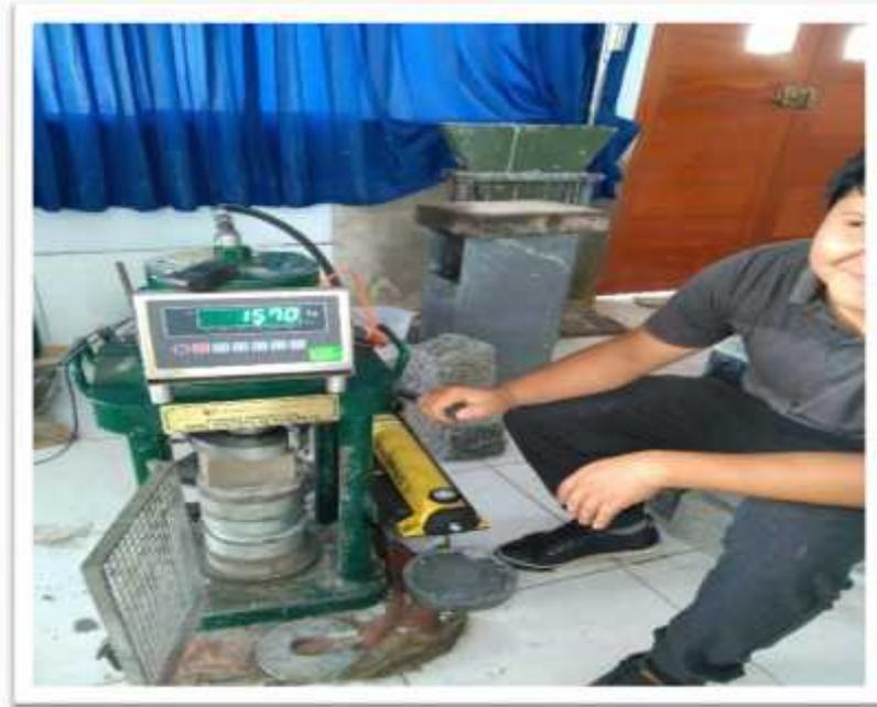
Figura N° 22: Ensayo a la compresión del adobe estabilizado con 2.0%
