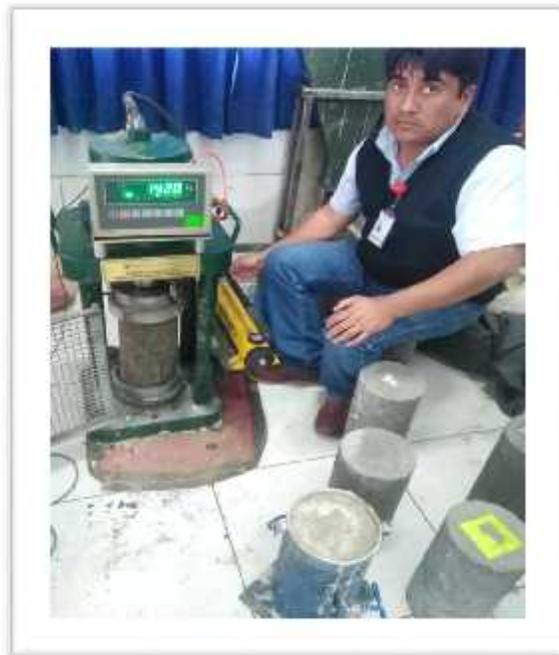
Figura N° 24: Ensayo a tracción de adobes estabilizados cilíndricos con sustitución de 2% (periodo de 28 días).
