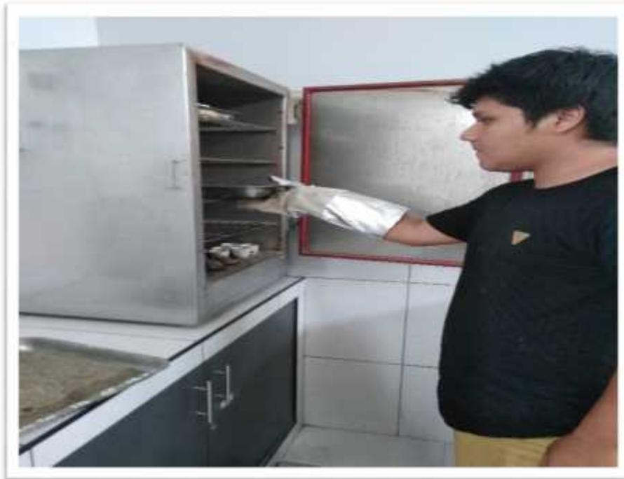
Figura N° 03: muestra de 1500 g, introducida al horno para
