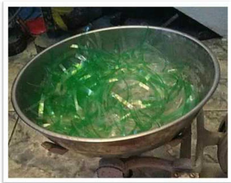
Figura N° 14: Pesaje de las fibras de tereftalato de polietileno para 0.5%, 1.0% y 2.0% del bloque de adobe
