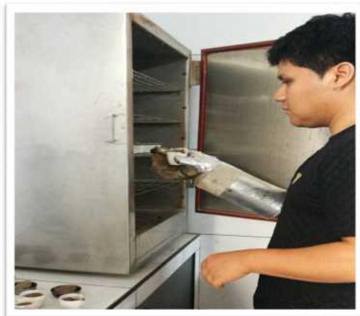
Figura N° 11: colocación de las taras en el horno.
