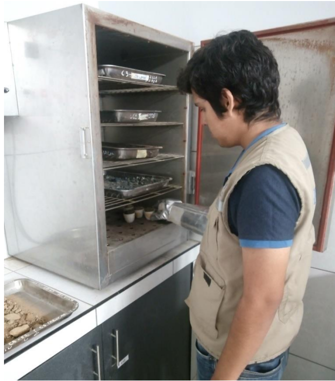
Foto N°9: Muestras secas en el horno del laboratorio de Mecánica de Suelos de la Universidad Cesar Vallejo.
