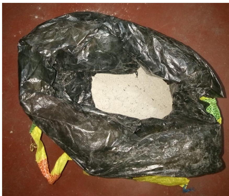
Foto N°8: Ceniza de paja de Trigo a 550 °C.
