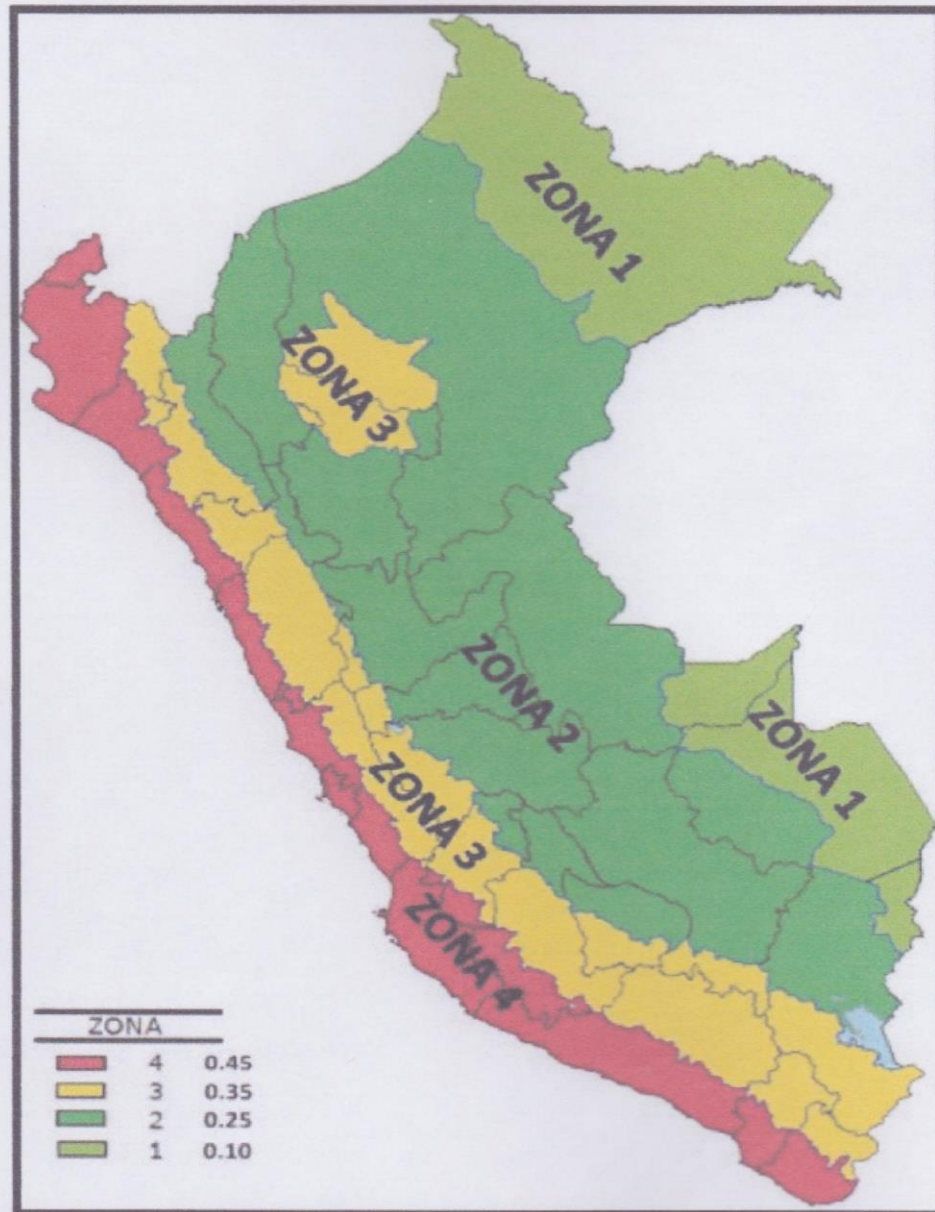
FIGURA N° 1: Mapa de Zonificación Sísmica del Perú, según el Reglamento Nacional de Edificaciones (2016).
