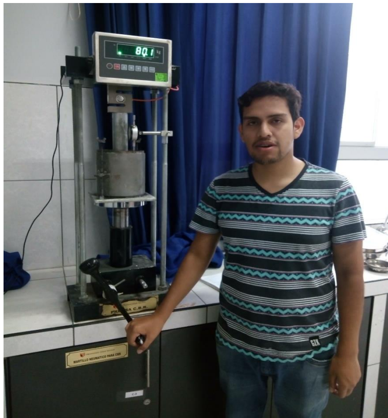
Foto N°12: Ensayo CBR de las muestras obtenidas de las calicatas.
