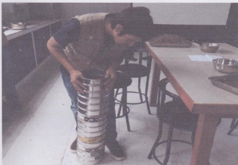
En la imagen se aprecia la realización del tamizado el cual tomara entre unos 10 minutos
