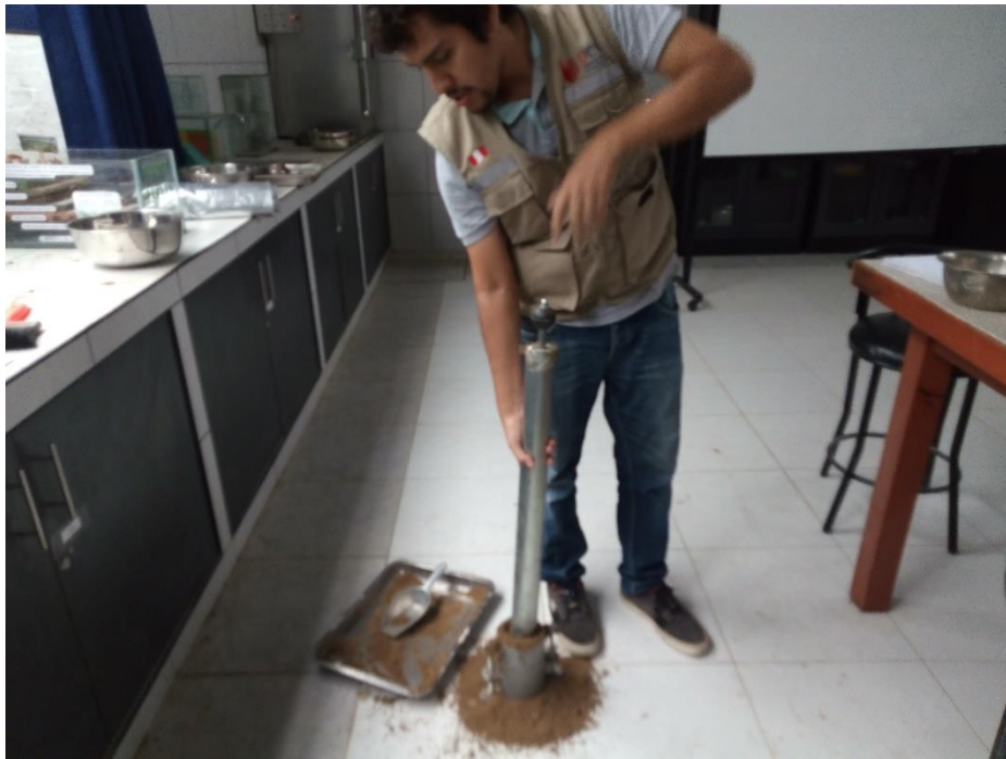
Foto N°11: Ensayo Proctor Modificado de las muestras obtenidas de las calicatas.
