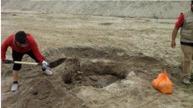
**Figura 7:** Realizando la excavación manual para la extracción de muestra y a posterior ser analizada en el laboratorio.
