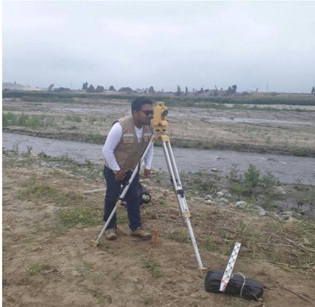
**Figura 5:** Realizando la topografía en la zona de estudio para la obtención de niveles.
