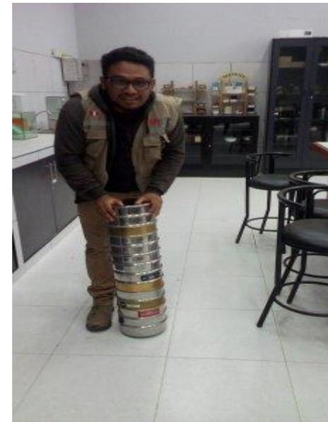
**Figura 6:** Realizando el ensayo de granulometría en el laboratorio.
