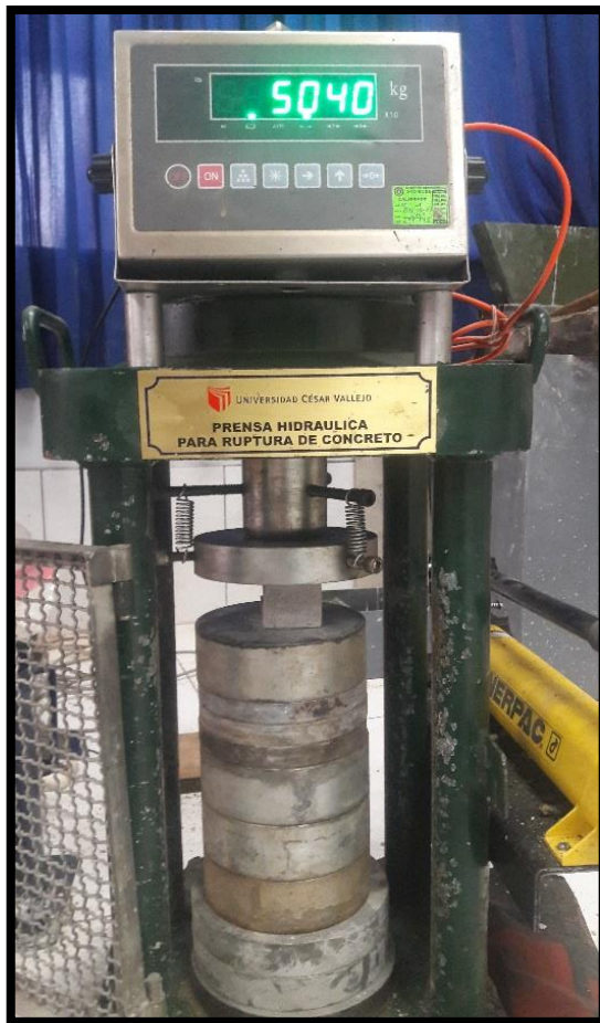
Ensayo a compresión de cubos
