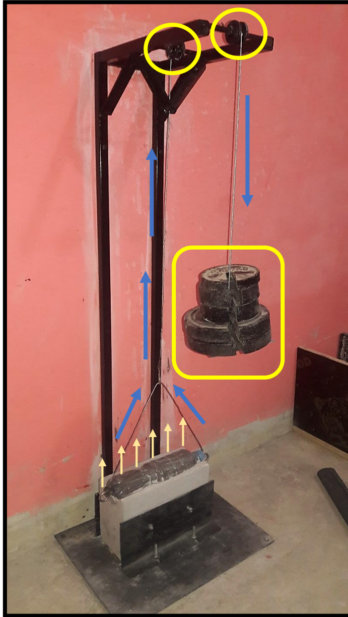
IMAGEN N° 3: Colocación de las pesas en la estructura.
