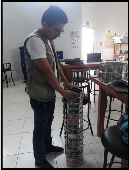
**IMAGEN 03:** Ensayo granulométrico del material de afirmado de las Canteras Pampa La Colina – Guadalupto y San Pedrito – Samanco.
