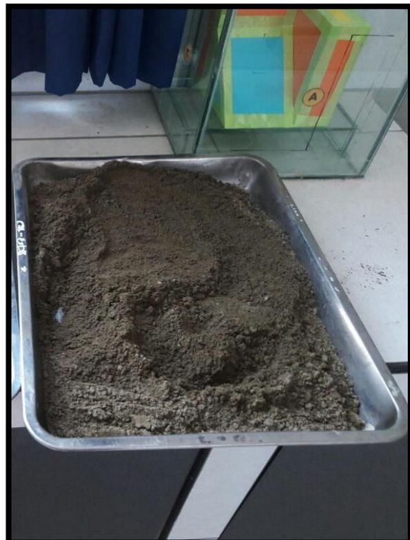
**IMAGEN 13:** Muestra de grava retenida por el tamiz #40 del material de Afirmado de la Cantera San Pedrito, para adición y mejoramiento del material de afirmado de Cantera Pampa La Colina.
