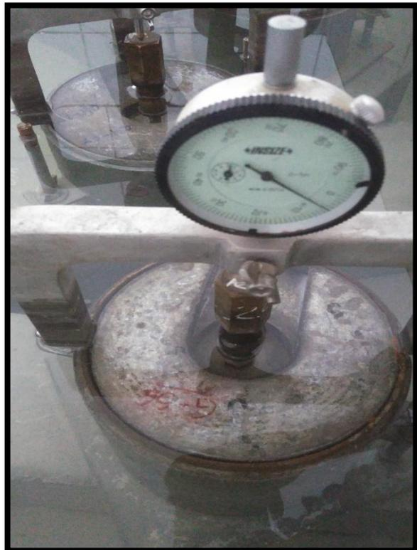
**IMAGEN 17:** Molde CBR expuesta a la Prensa CBR, para su resultado final.
