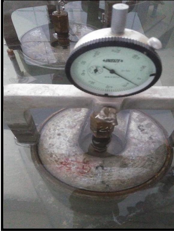
**IMAGEN 15:** Muestra en molde CBR del material de afirmado de la Cantera San Pedrito- Samanco, expuesta al agua durante 4 días.
