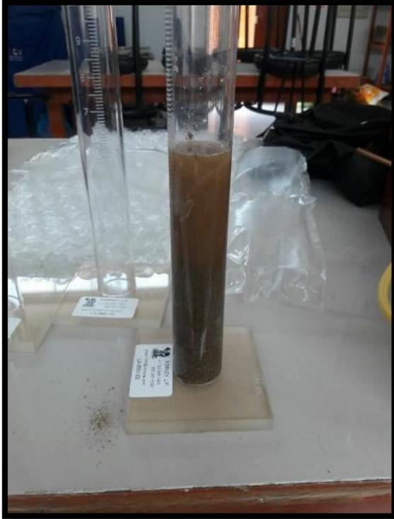
**IMAGEN 07:** Ensayo de Equivalente de arena para el material de afirmado de las canteras Pampa La Colina – Guadalupito y San Pedrito – Samanco.
