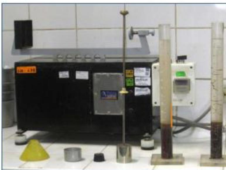
Figura 4 – Agitador mecánico y dispositivo de pesado de plé
