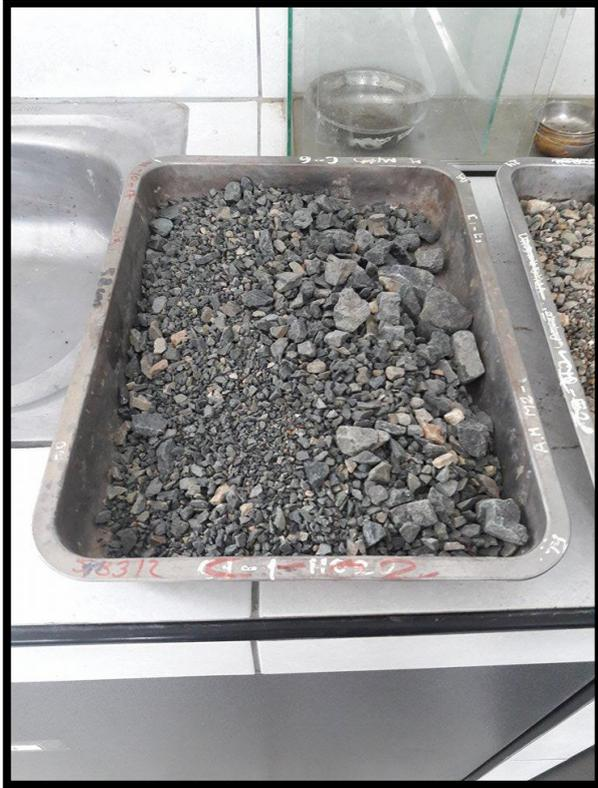
**IMAGEN 09:** Muestra pasada por el tamiz #4 del material de Afirmado de la Cantera “San Pedrito – Samanco para ensayo de Abrasión.
