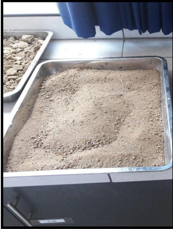
**IMAGEN 11:** Muestra pasada por el tamiz #4 del material de Afirmado de la Cantera Pampa La Colina – Guadalupito para ensayo de CBR
