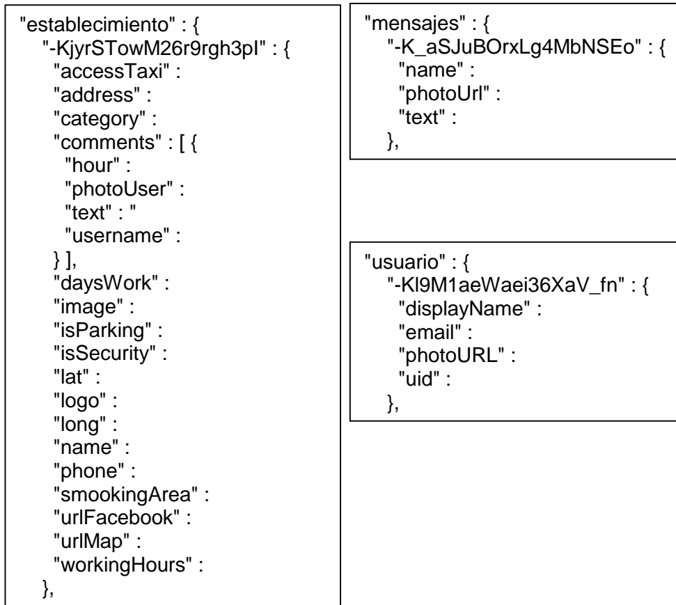
Diagrama 24 Diagrama de Modelo de Datos - NoSQL
