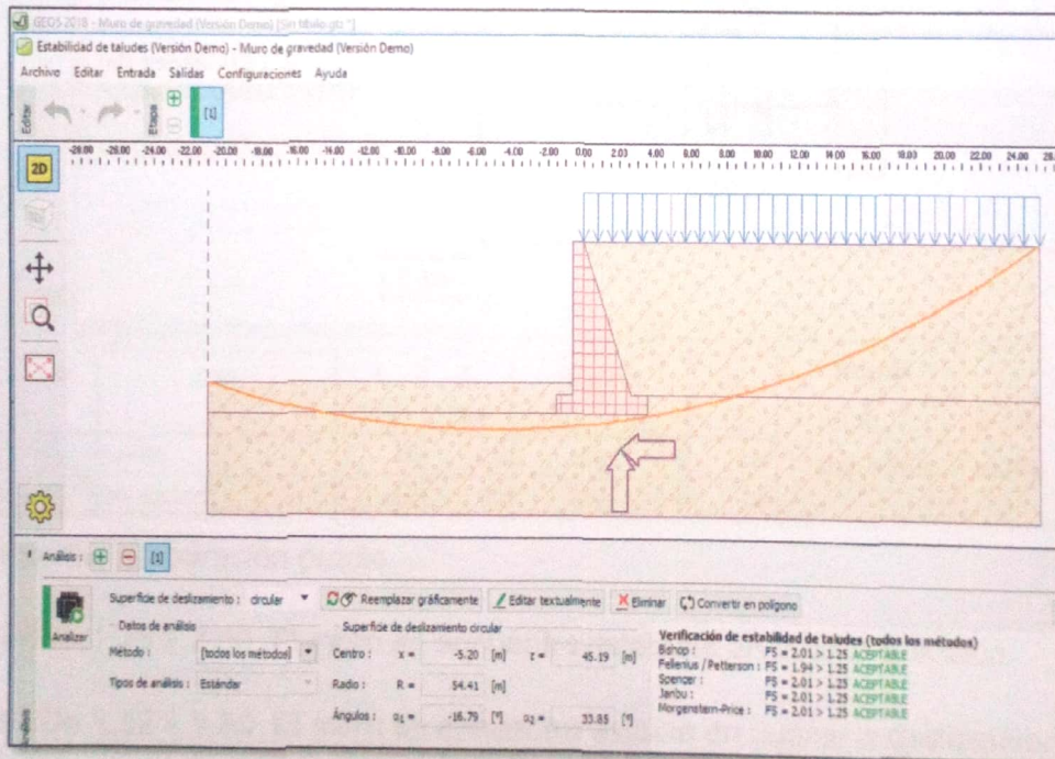
Figura 127. Estabilidad global método muro gravedad N° 2
