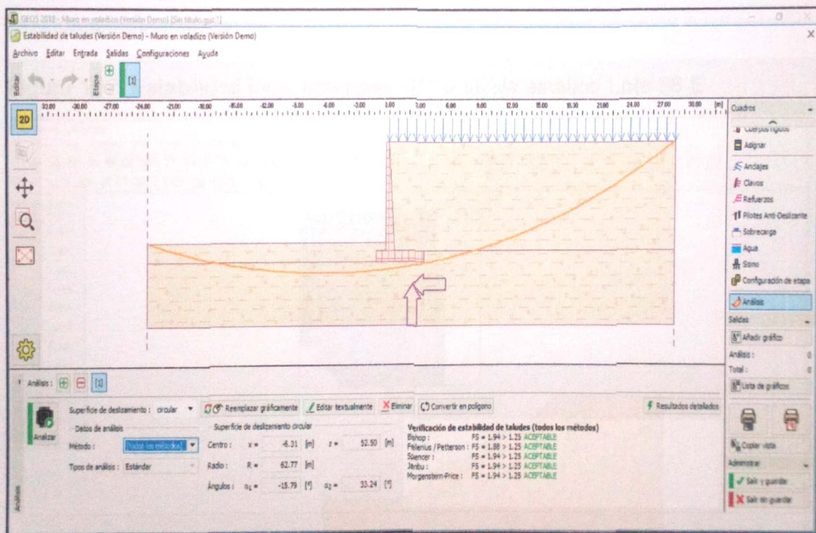
Figura 105. Verificación de estabilidad del talud lote 66 E
