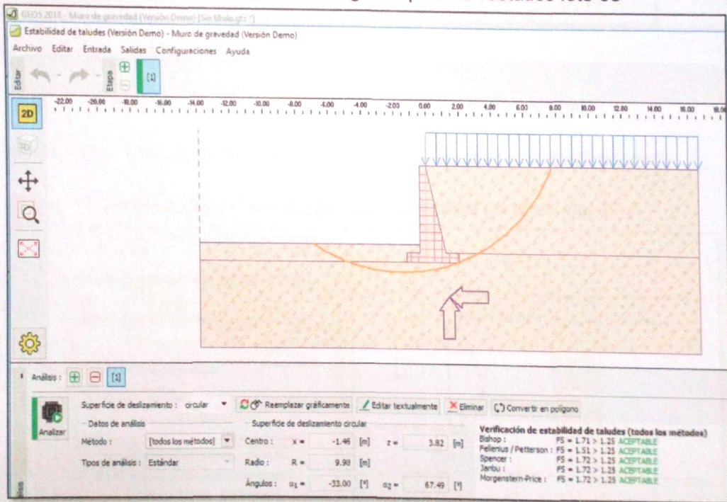
Figura 68. Software Geo 5 Estabilidad global pseudo- estático lote 68
