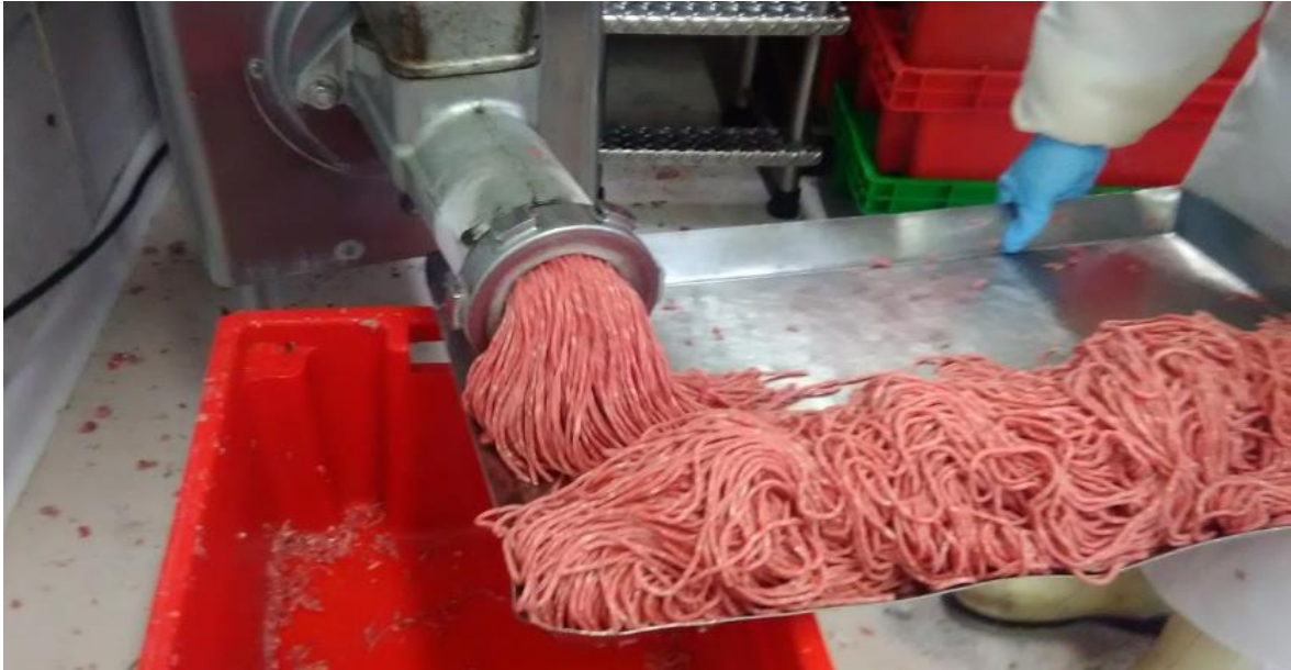
Figura 18: Carne molida saliendo de moledora de carne con 2do disco.
