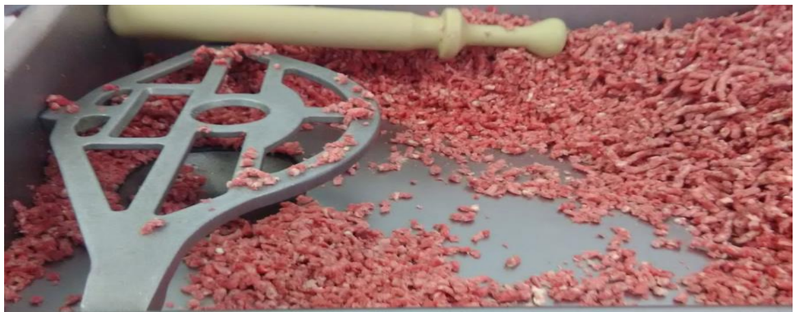
Figura 17: Carne molida gruesa pasando por el 2do disco. Fuente: Elaboración propia.
