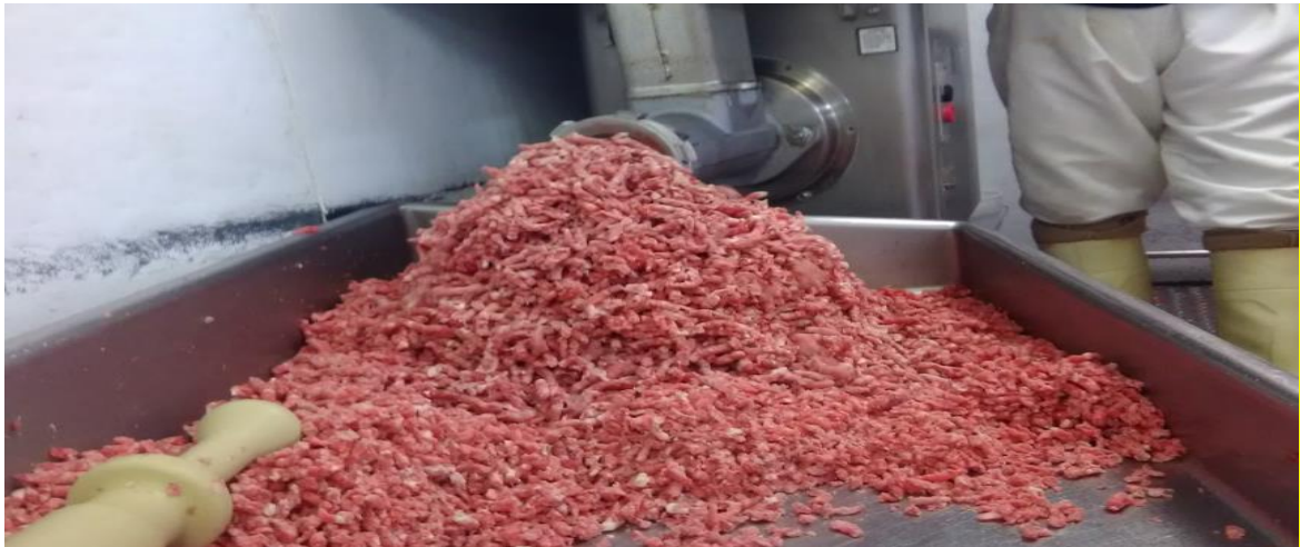
Figura 16: Trozos de molida de carne con el 1er disco (molida gruesa). Fuente: Elaboración propia.
