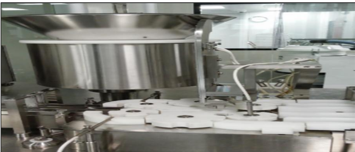
Figura 17. Estación de taponado de la máquina Dosificadora de polvo Cima EV-569.
