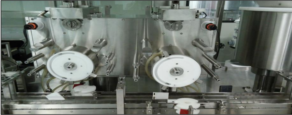
Figura 16. Estación de dosificado de la máquina Dosificadora de polvo Cima EV-569.
