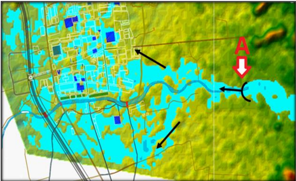
Figura 22. Inicio del desborde del Río Huarmey. Fuente: Elaboración propia.
