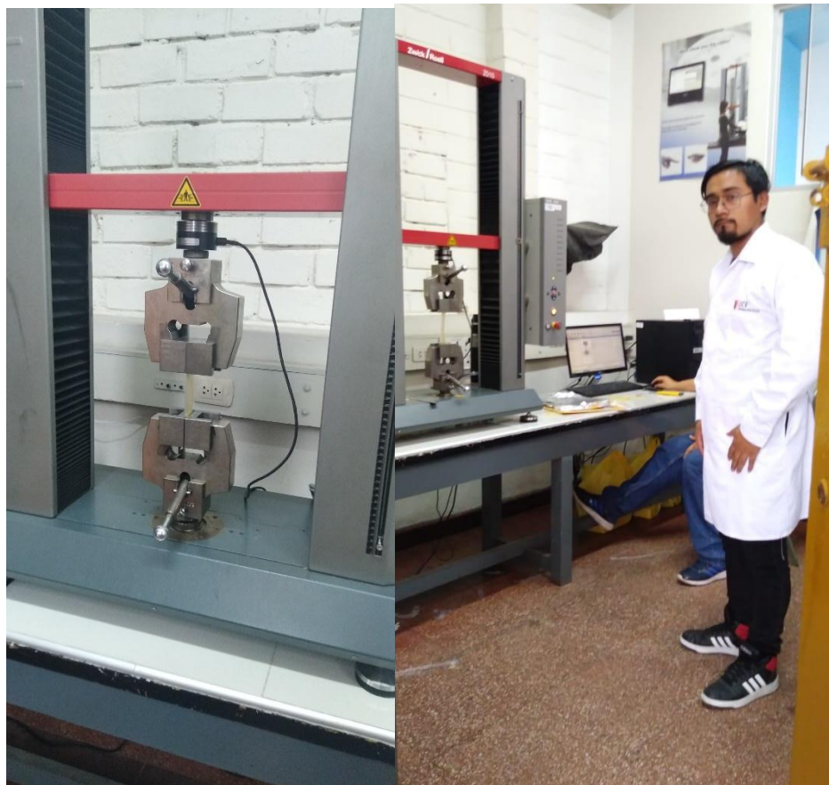
Foto N°22. Bioplástico obtenido de la cáscara de la Musa balbisiana sometido a ensayos de tracción, elongación y degradabilidad. Laboratorio LABICER-UNI.
