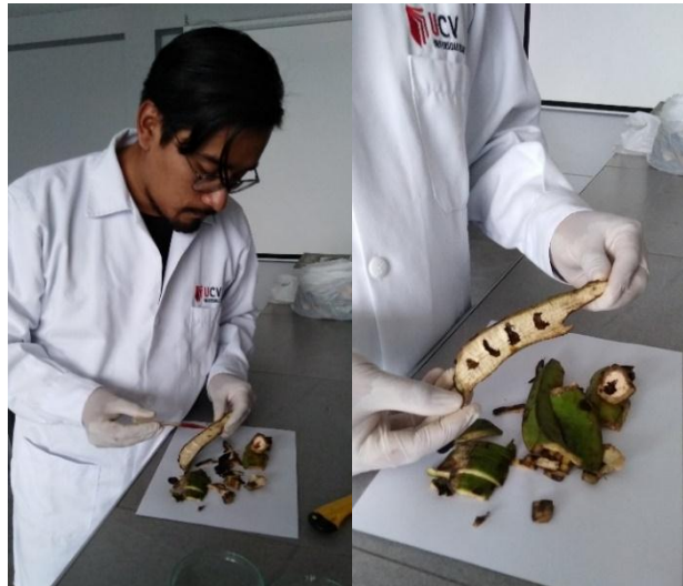
Foto N°10. Detección de la presencia de almidón agregando Lugol, ante la presencia de almidón el yodo cambia de un color ámbar a un violeta oscuro
