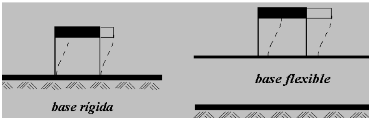
Figura 9. Interacción dinámica suelo estructura con diferentes tipos de base de suelo
