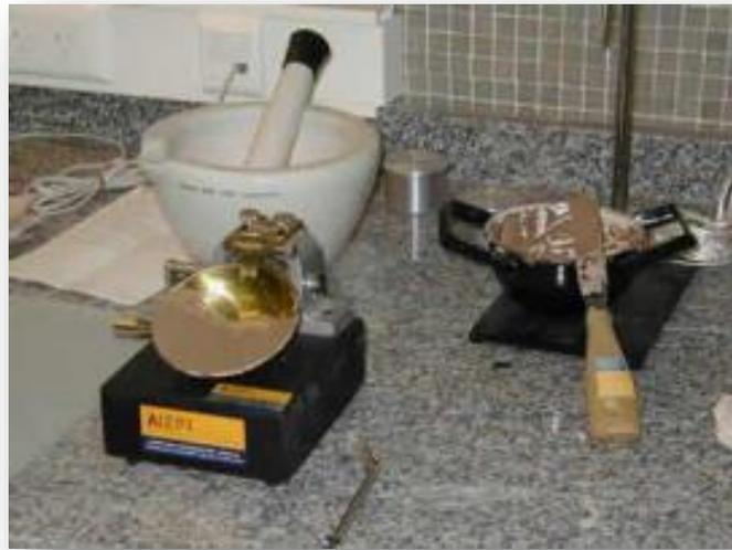
**Figura 34.** Ensayo de límite líquido
