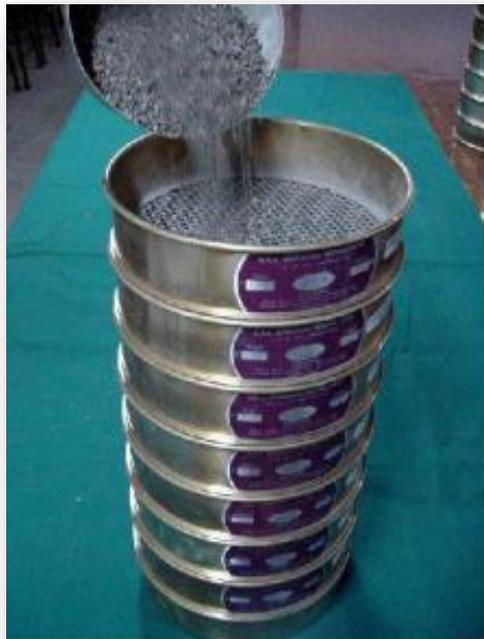
**Figura 28.** Tamizado de la muestra
