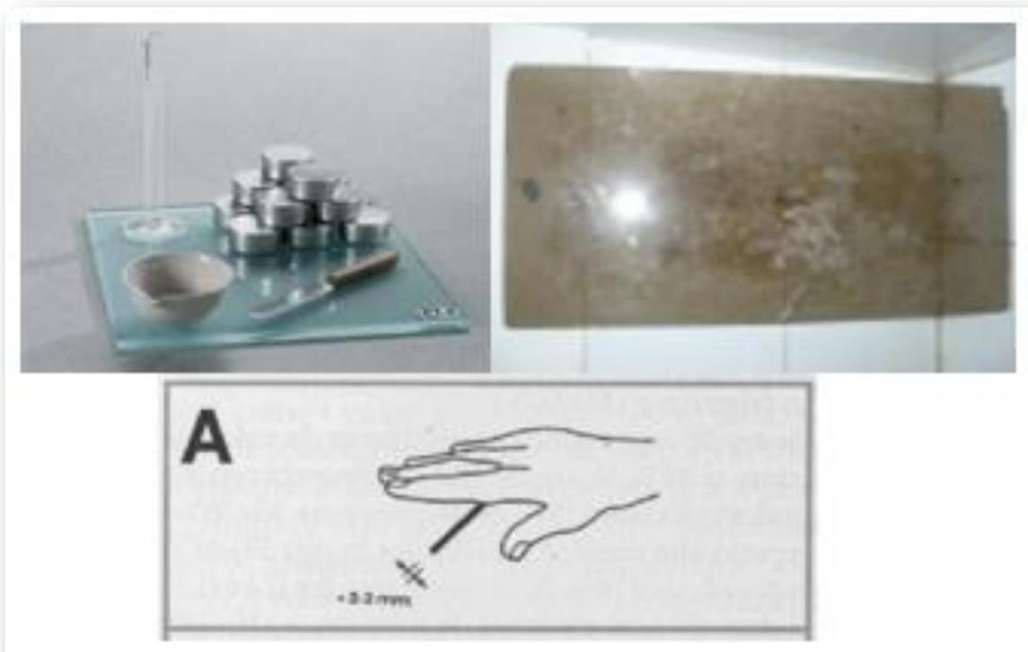
**Figura 36.** Elementos de ensayo – Limite plástico
