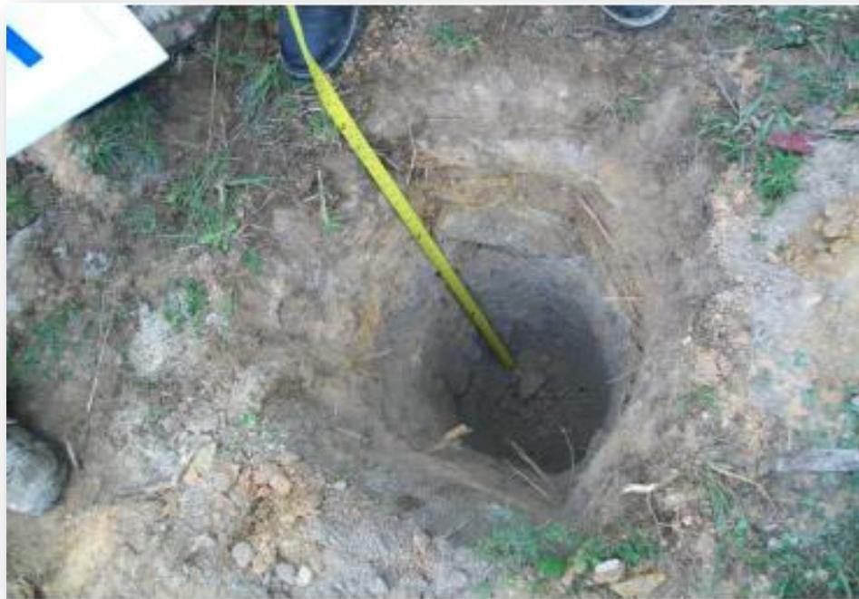
**Figura 18.** Medición de la profundidad de las calicatas
