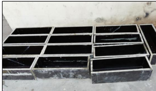
Figura 40: Moldes para elaboración de las muestras.
