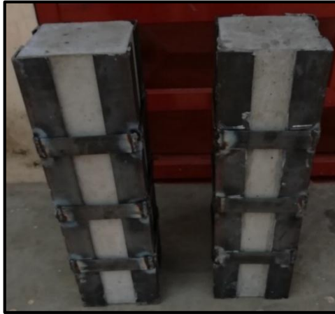
Figura 43: Reforzamiento de empresillado metálico
