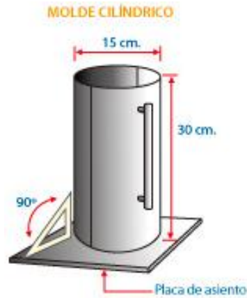
Figura 39: Molde cilíndrico de 15x30 cm
