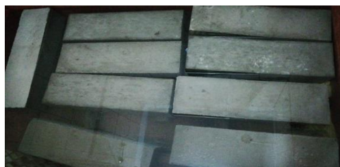
Figura 41: Curado de vigas
