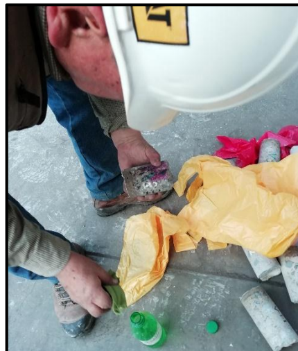
Figura 16: Ensayo de carbonatación
