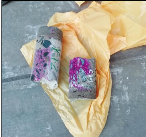
Figura 17: Indicador colorimétrico de estimación del nivel de carbonatación
