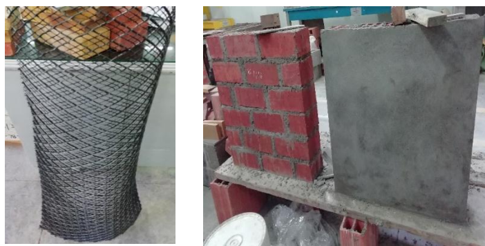
Figura 42: Reforzamiento de muros con geomalla triaxial
