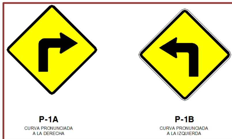
Figura 21. Señalización de curvas pronunciadas
