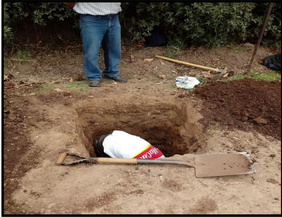
Figura 28. Extracción de muestras de suelo.
