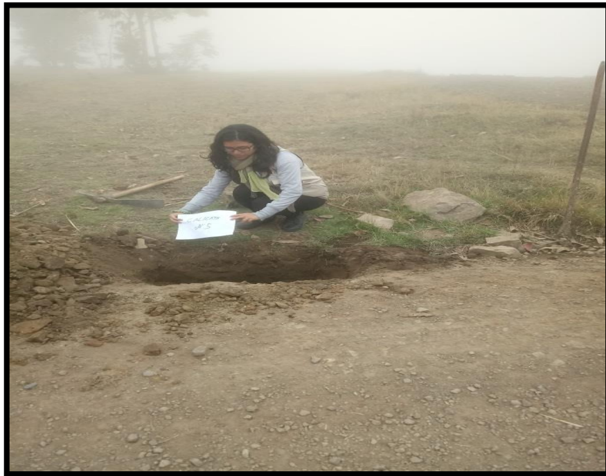
Figura 29. Extracción de muestras de suelo.
