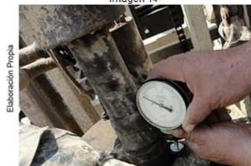
Pruebas realizadas con el tacómetro
