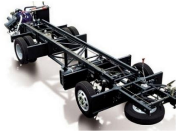
Imagen 1, Bastidor de largueros longitudinales
