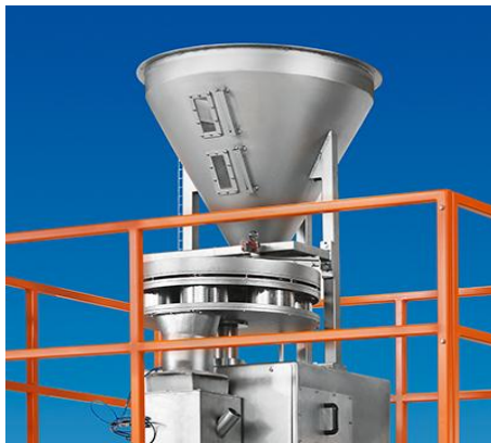
Imagen 15, Tolva con dosificador Volumétrico
