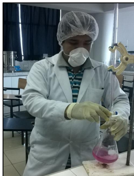
Figura 14. Determinación de acidez titulable
