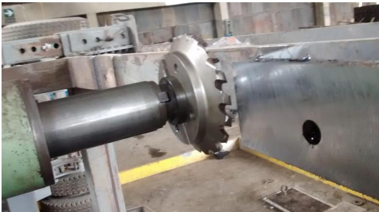
Figura 72 Maquina cepilladora para mecanizado de la viga con plancha para acentar los apoyos de la trituradora (Foto-Comeco)
