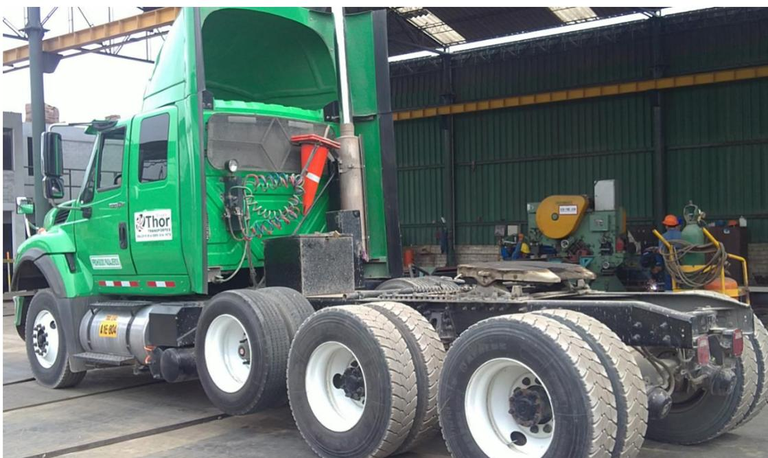
*Figura 88. Tractor de tres ejes para trituradora móvil (Foto de comeco)*
