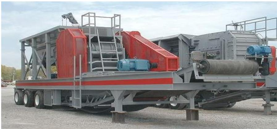
Figura 20. Portable de trituración de mandíbula impacto (Fuente foto
