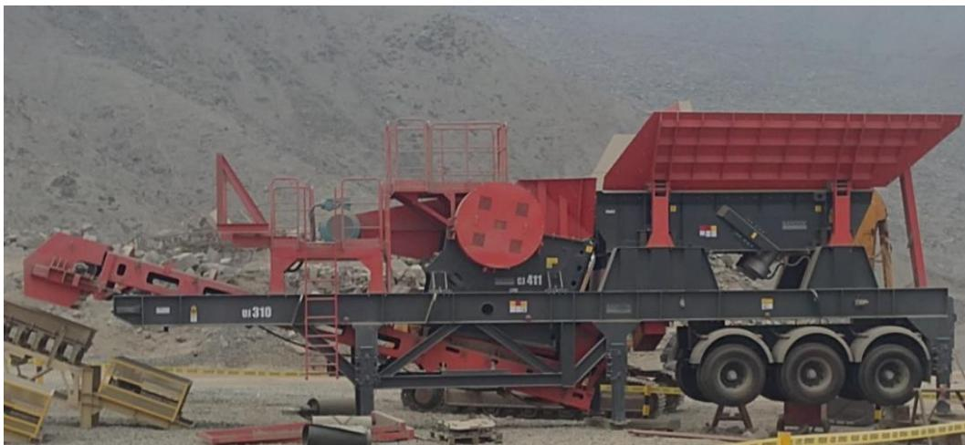
*Figura 22. Portable de trituradora móvil quijada sandvik (Fuente foto en Suecia)*
