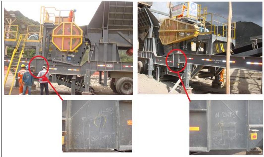
**Figura 24.** Soporte de portable con fatiga
