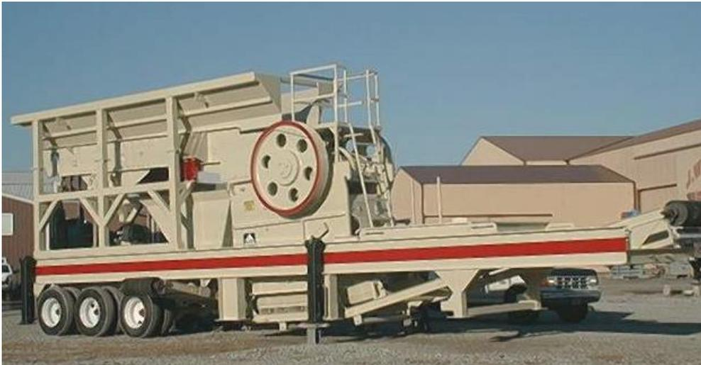
*Figura 21. Portable de trituración móvil de mandíbula Trio (Fuente foto en Shaghai-China)*
