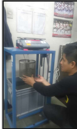
Figura 12: Secado superficial de agregado grueso, peso específico de agregado grueso y fino.
