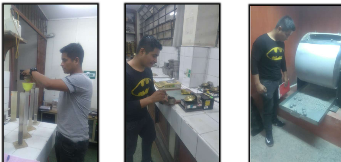
Figura 14: Ensayo de equivalente de arena, límites de Atterberg y abrasión Los Ángeles
