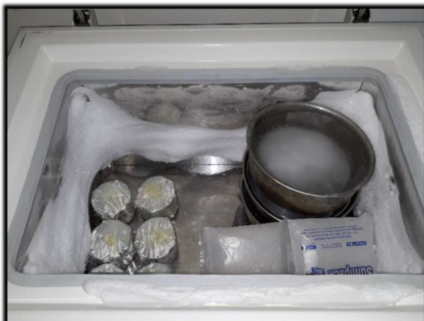
Briquetas de mezcla asfáltica convencional y modificada acondicionadas al congelamiento y baño amarilla
