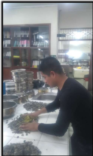
Figura 12: Secado superficial de agregado grueso, peso específico de agregado grueso y fino.
