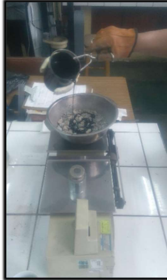
Ensayo de adherencia, mezclado de agregados con bitumen (asfalto) y equipo de compactación
