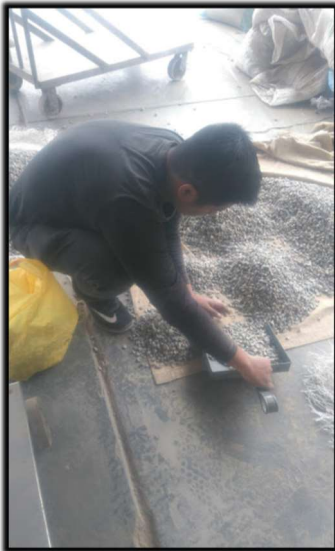
Figura 11: Cuarteo, inspección visual y tamizado de agregado grueso
