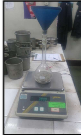
Figura 12: Secado superficial de agregado grueso, peso específico de agregado grueso y fino.
