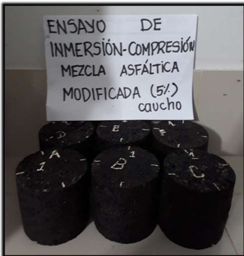
Briquetas de mezcla asfáltica modificada para realizar ensayo de resistencia inmersión compresión
