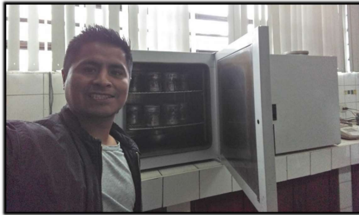
Agregado grueso y fino en horno a 145 \pm 5 °C
