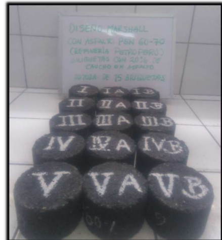
Briquetas de mezcla asfáltica modificadas con granos de caucho al 10% y 20%
