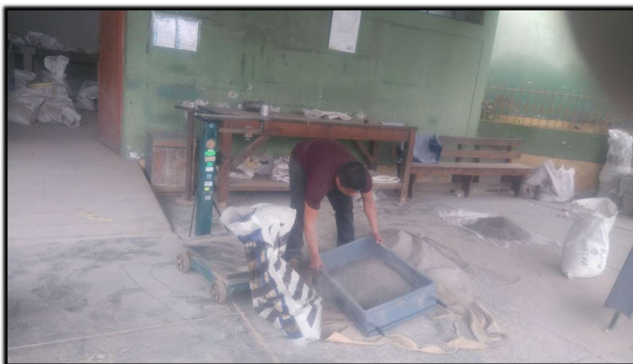
Figura 10: Tamizado de agregado fino (300 kg) y grueso (300 kg).
