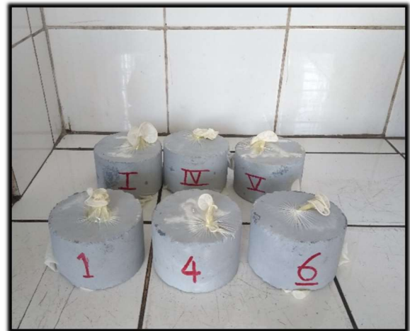
Briquetas de mezcla asfáltica convencional y modificada acondicionadas en presión al vacío
