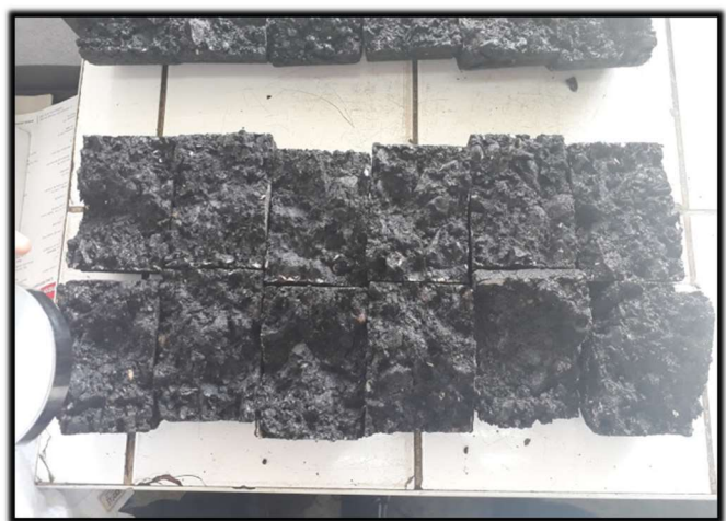
Perdida de adherencia entre el bitumen asfalto caucho y los agregados de la mezcla asfáltica modificada
