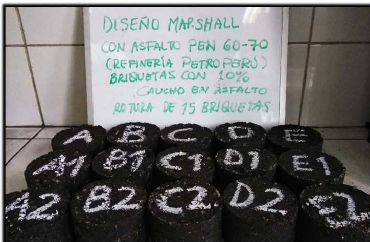
Briquetas de mezcla asfáltica modificadas con granos de caucho al 10% y 20%
