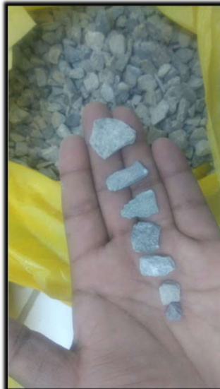
Figura 11: Cuarteo, inspección visual y tamizado de agregado grueso
