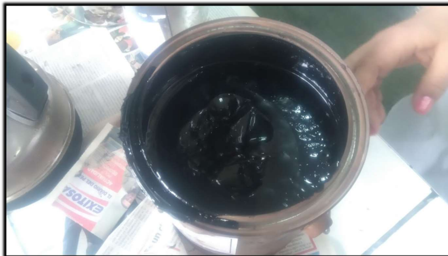
Figura 18: Bitumen final modificado con granos de caucho.
