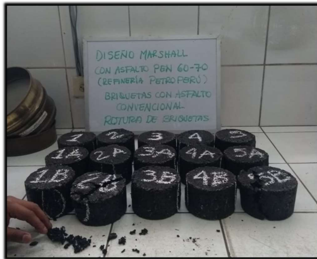
Briquetas de mezcla asfáltica convencional ensayadas
