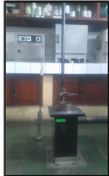
Ensayo de adherencia, mezclado de agregados con bitumen (asfalto) y equipo de compactación
