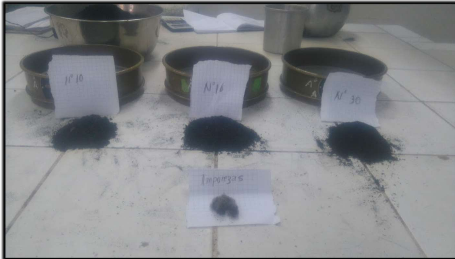
Figura 16: Granulometría e impurezas en granos de caucho.
