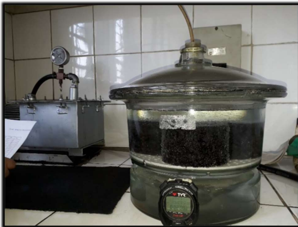
Briquetas de mezcla asfáltica convencional y modificada acondicionadas en presión al vacío
