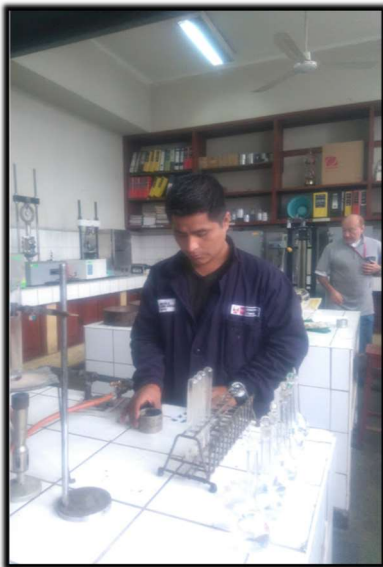
Ensayo de adherencia, mezclado de agregados con bitumen (asfalto) y equipo de compactación
