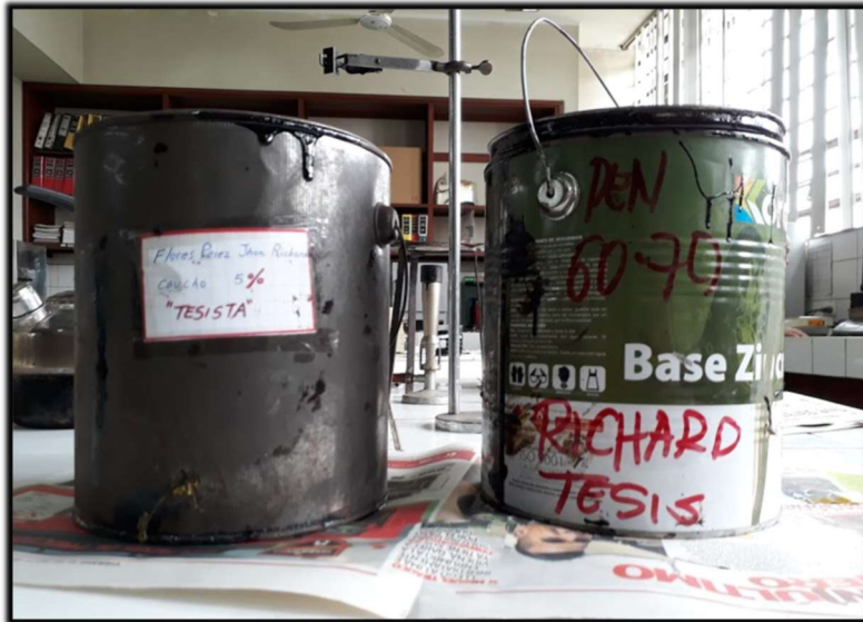
Asfalto modificado con 5% granos de caucho y asfalto convencional (0%)
