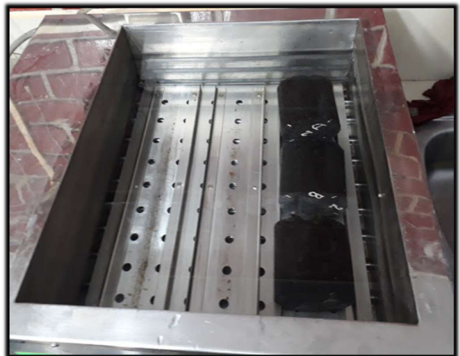
Briquetas de mezcla asfáltica modificada para realizar ensayo de resistencia inmersión compresión
