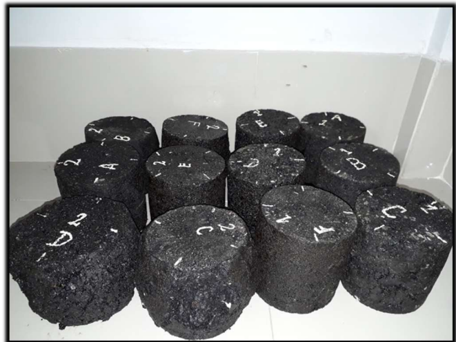
Briquetas de mezcla asfáltica convencional para para realizar ensayo de resistencia inmersión compresión
