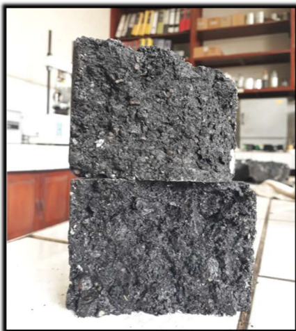
Perdida de adherencia entre el bitumen asfalto caucho y los agregados de la mezcla asfáltica modificada
