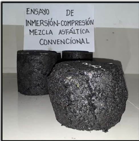
Briquetas de mezcla asfáltica convencional para para realizar ensayo de resistencia inmersión compresión
