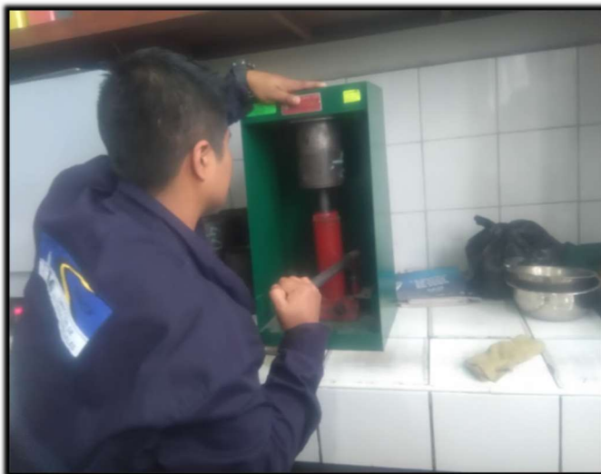
Desmolde de briquetas y ensayo Marshall
