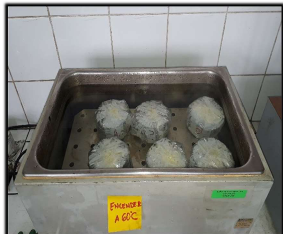
Briquetas de mezcla asfáltica convencional y modificada acondicionadas al congelamiento y baño amarilla
