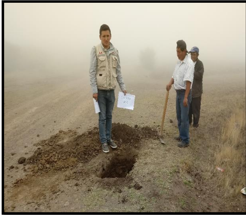
Figura 47. Extracción de muestras de las calicatas
