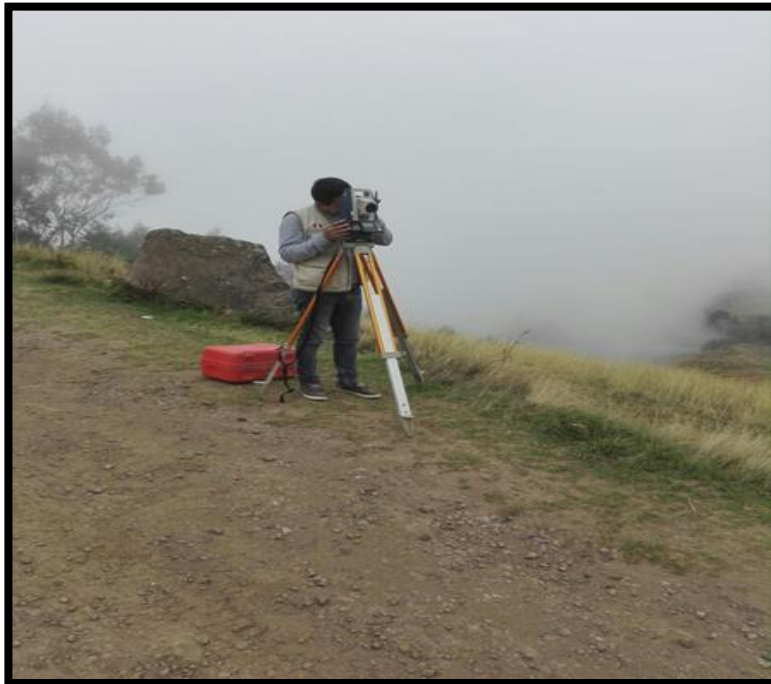
Figura 46. Levantamiento topográfico de la carretera
