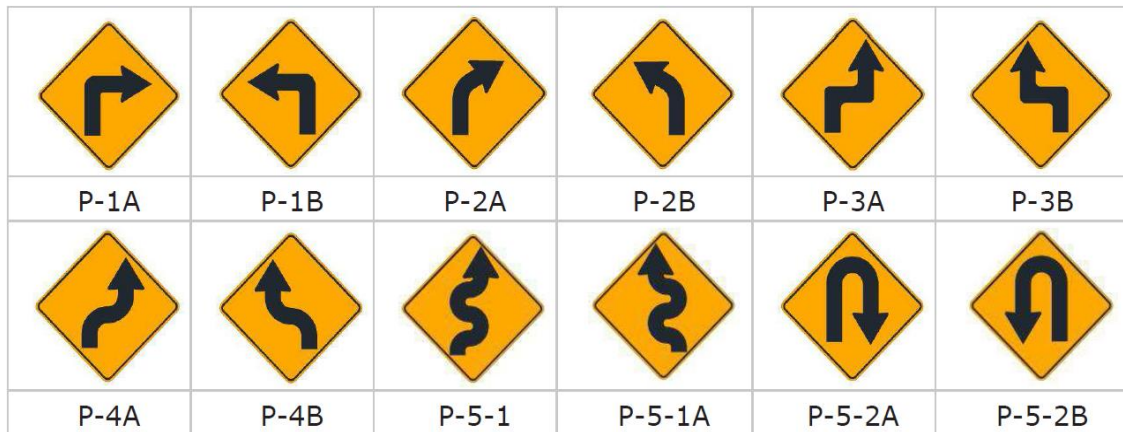
Figura 31. Señales preventivas - curvatura horizontal
