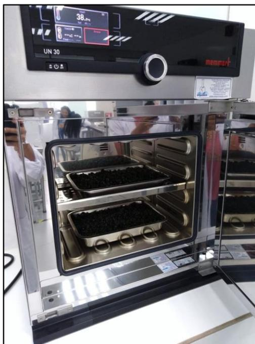
**Figura N°3:** Secado de la muestra de *Nostoc commune* (Cushuro) a 40°C en estufa
