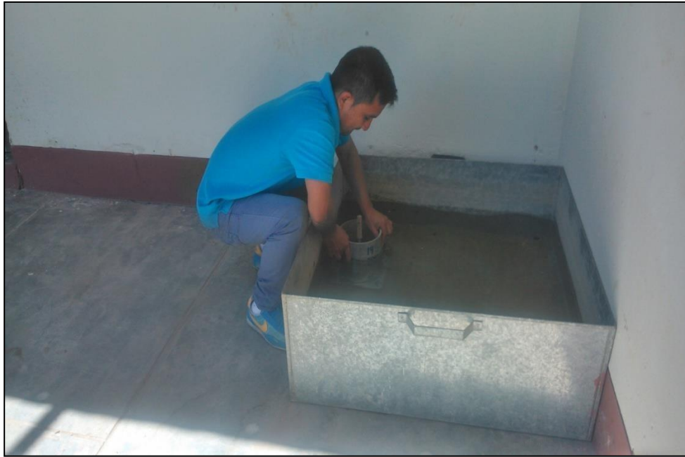
Figura 8. Sacando muestra para CBR
