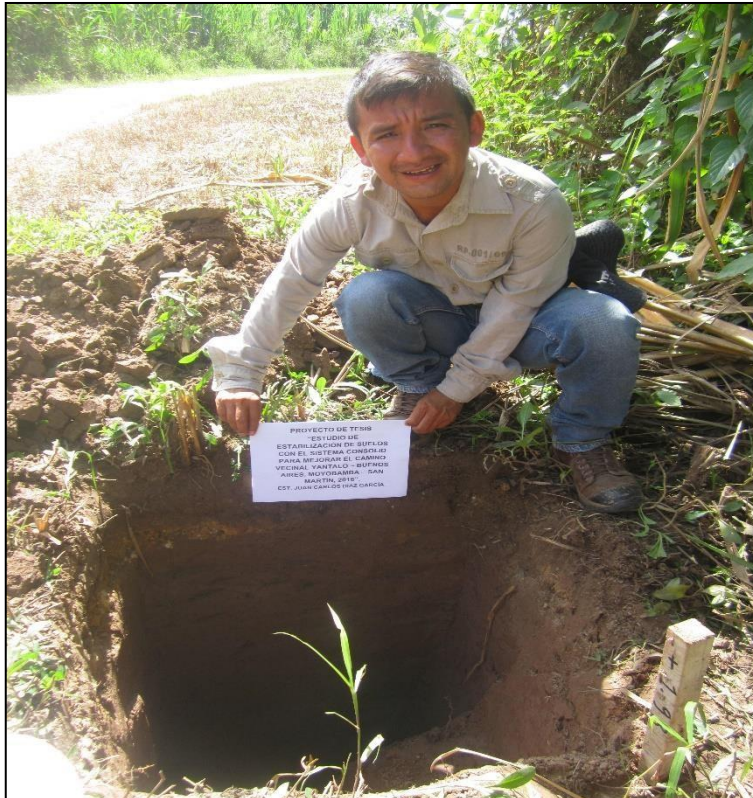
Figura 17. Muestras de la calicata
