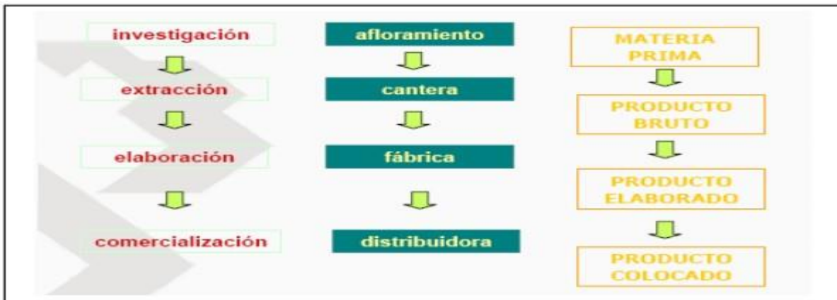
Figura 1. 2 Etapas para la explotación de una cantera
