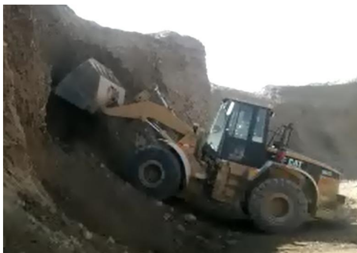
Fotografía 3. 5 Cargador frontal extrayendo material de estrato húmedo
