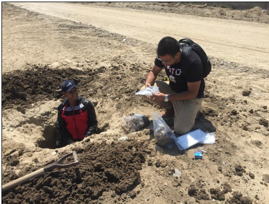
Figura 31. Registro de muestras por cada estrato encontrado por el investigador, para que sean dirigidos hacia el laboratorio de mecánica de suelos de la Universidad Cesar Vallejo.
