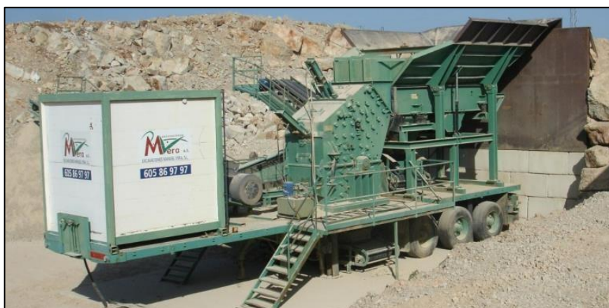
Figura 50. Tolva metálica de recepción de 20 m 3 de capacidad.
