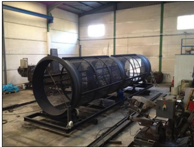
Figura 52. Trommel de clasificación de 6m x 1'9m.
