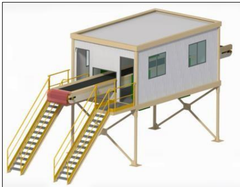
Figura 54. Cabina de triaje de obra CTR 6.
