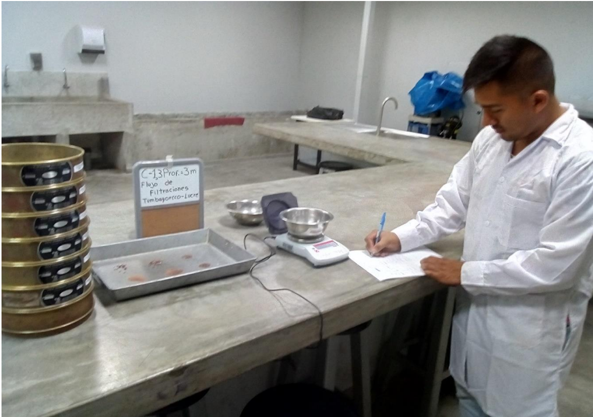
Figura 65. Ensayo de tamizado y granulometría, laboratorio de mecánica de suelos de la UCV, fuente elaboración propia, 2018
