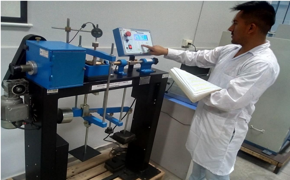
Figura 64. Ensayo de corte directo, laboratorio de mecánica de suelos de la UCV, fuente elaboración propia,2018.
