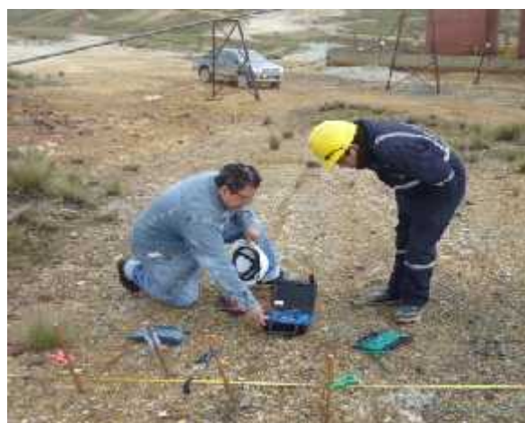
Fotografía mediciones de la resistencia del terreno
