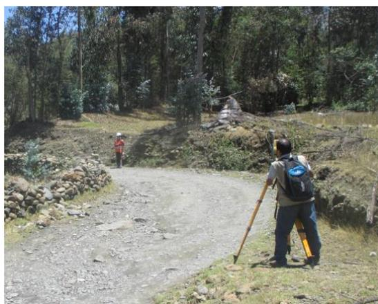
**Ilustración 4: Levantamiento Topográfico**
