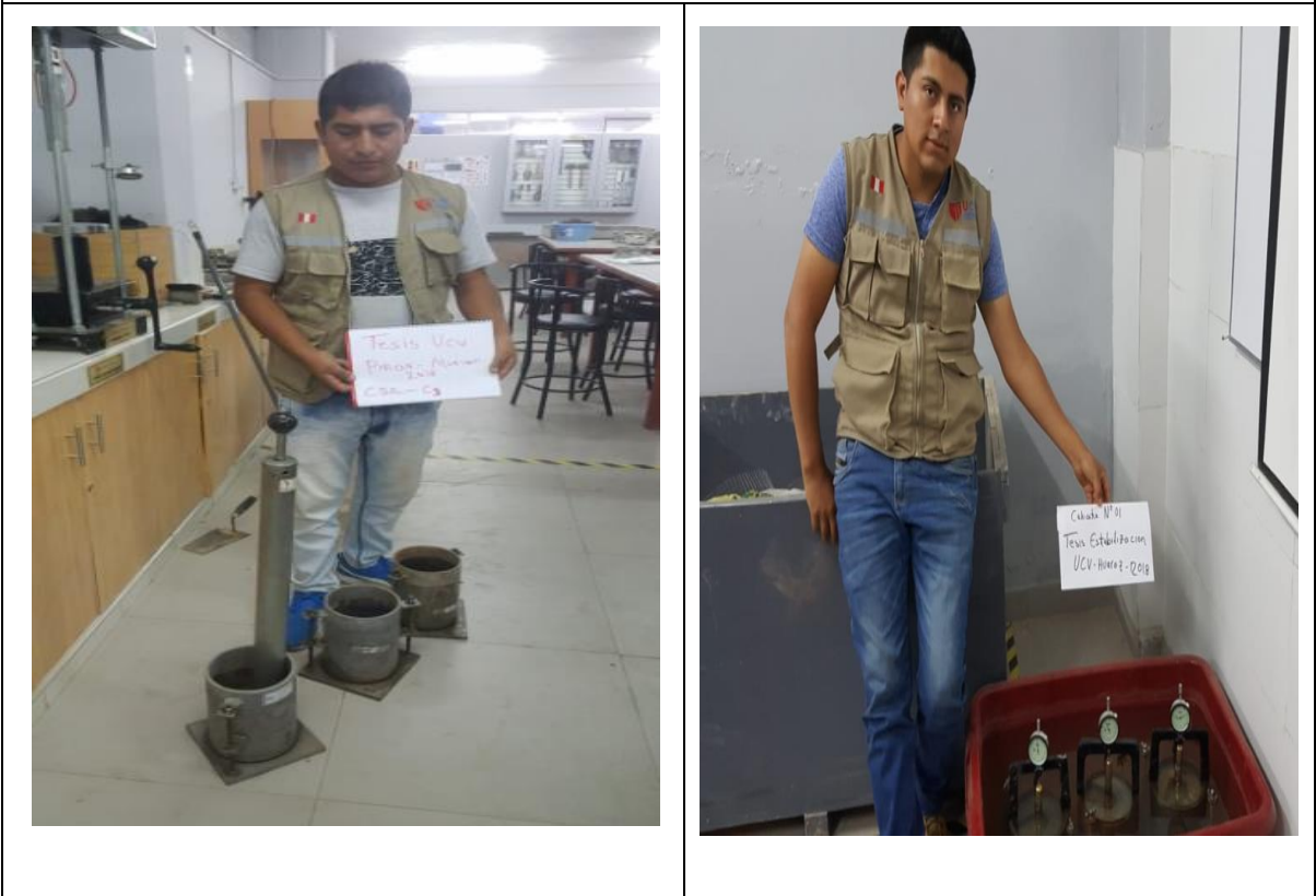
Figura 61. Ensayo de CBR del suelo con adición de cenizas de caña de azúcar
