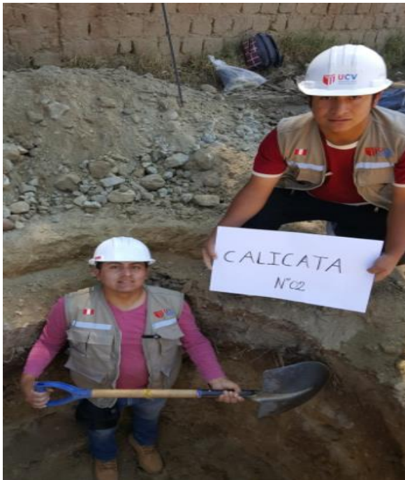
Figura 37. Excavación de las calicatas del lugar de estudio
