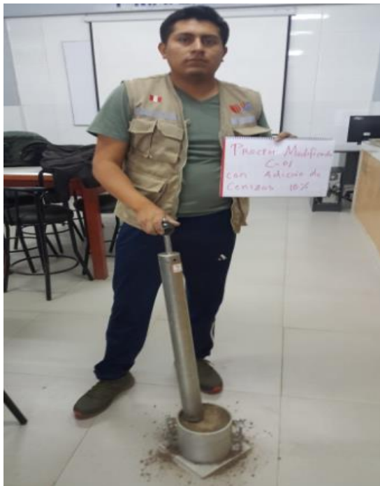
Figura 54: Proctor Modificado con adición de cenizas C-01
