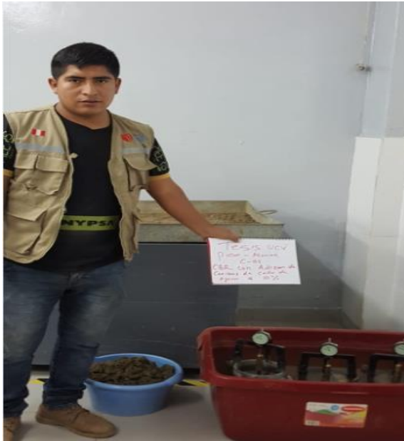
Figura 56: Sumergido de la muestra de suelo-cenizas
