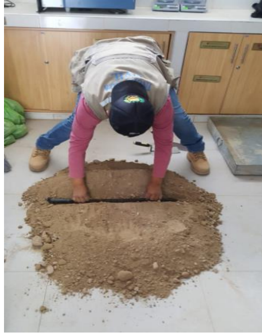
Figura 43: Cuarteo de la muestra de la calicata C-02
