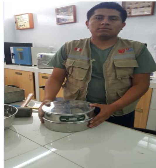
Figura 59. Proceso de tamizado de las cenizas
