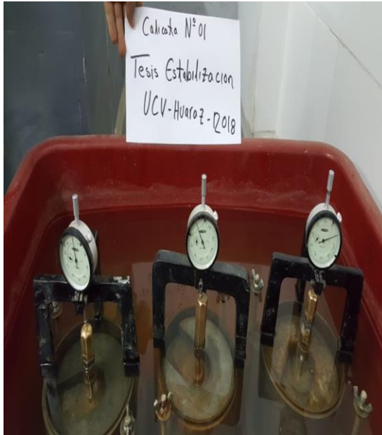
Figura 52: Muestra del suelo sumergido
