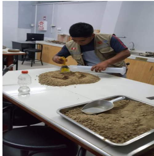
Figura 43: Cuarteo de la muestra de la calicata C-02
