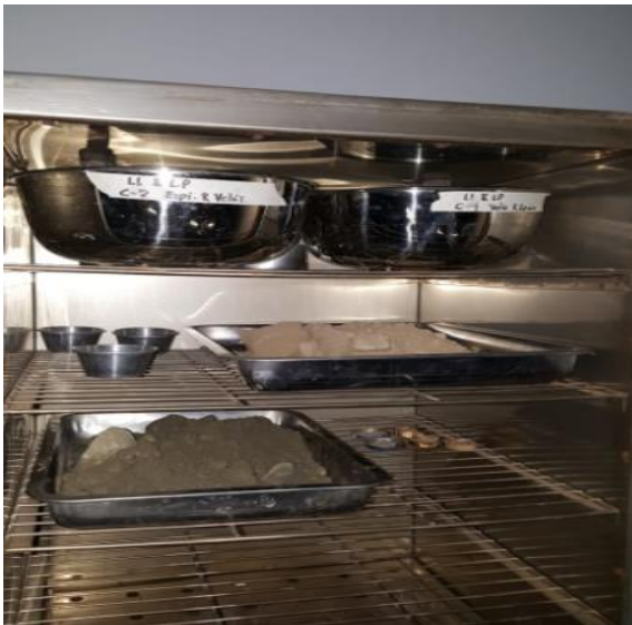
Figura 58. Muestras secadas al horno
