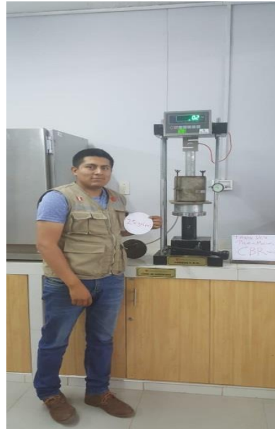
Figura 47: CBR del suelo natural C-01
