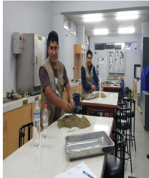
Figura 53: Mezcla del suelo con agua para el proctor modificado con adición de cenizas
