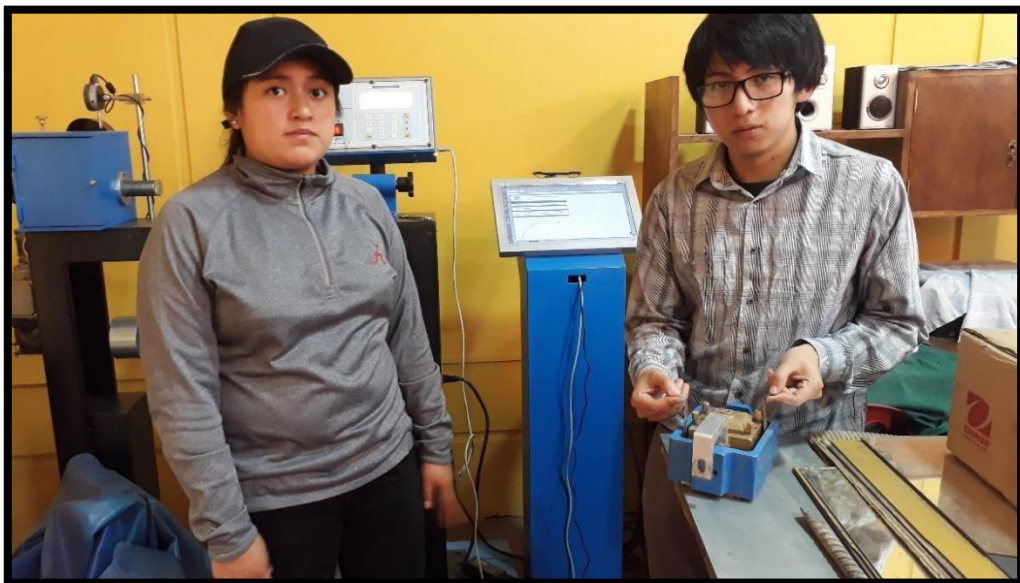
Imagen 8: Retirando la muestra del equipo de corte directo.
