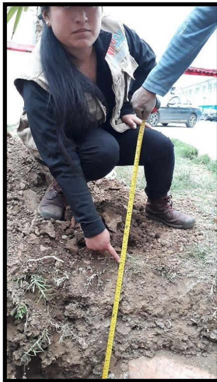
Imagen 4: Calicata a 2 metros de profundidad.
