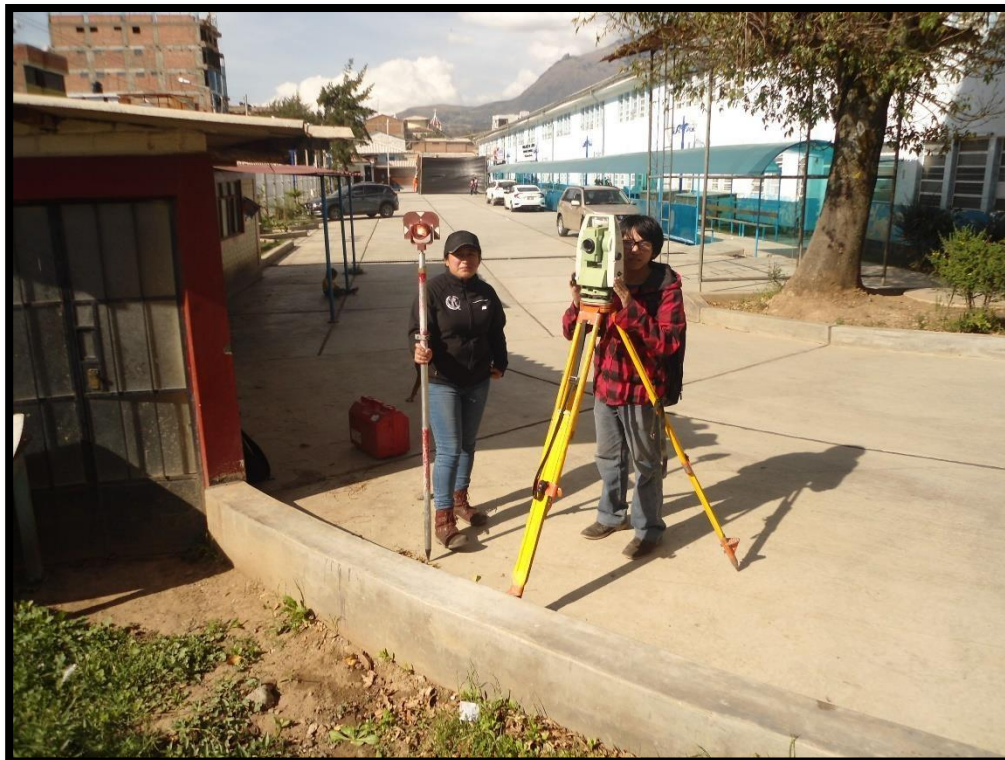
Imagen 9: Levantamiento topográfico en el estacionamiento del HVRG.
