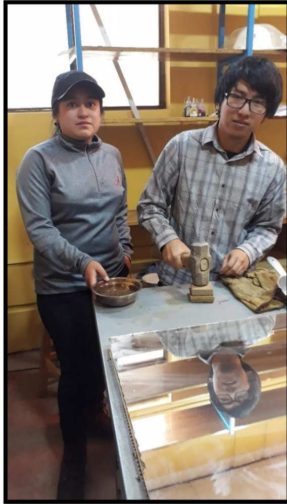
Imagen 7: Remoldeando la muestra de suelo extraída.
