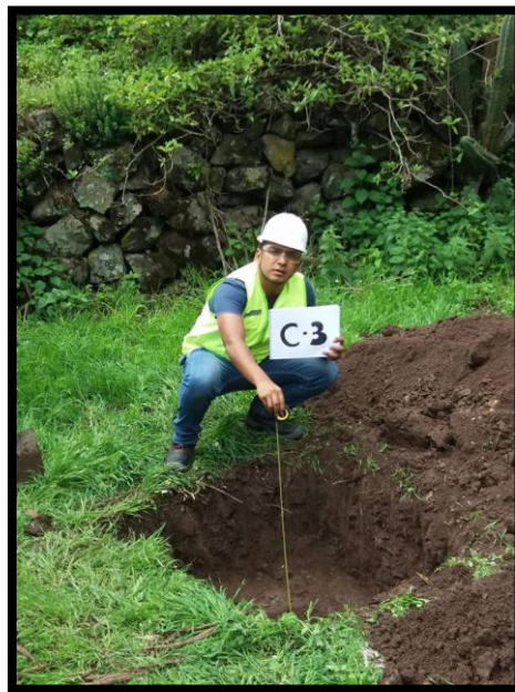
Fig. C1 – Excavación de calicata N° 3
