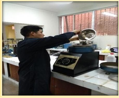
**Fotografía N° 07:** Colocación de la muestra asfáltica en la lavadora centrífuga
