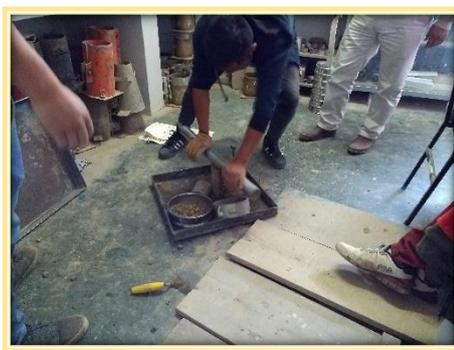
**Fotografía N° 03:** Enrase de material en el cilindro.
