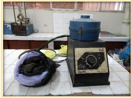
**Fotografía N° 02:** Lavadora centrífuga
