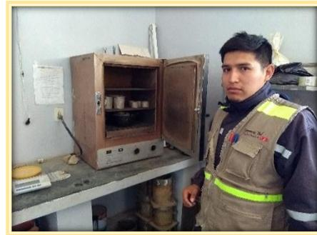
**Fotografía N° 02:** Determinación del contenido de humedad.
