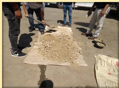
**Fotografía N° 01:** Uniformidad de Material granular
