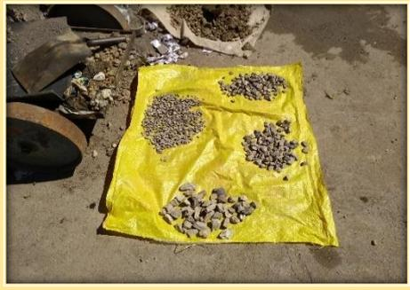
**Fotografía N° 03:** Cuarteo de Material granular
