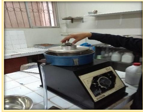
**Fotografía N°08:** Lavado del material asfáltico
