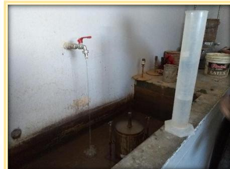
Fotografía N° 02: Material sumergido en el Estanque.
