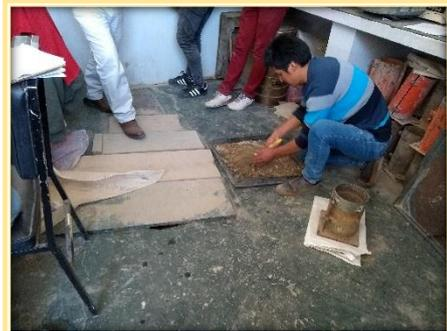
Fotografía N° 02: Colocación de material en el cilindro metálico
