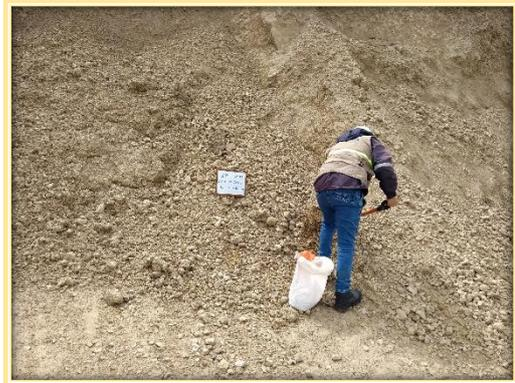
**Fotografía N° 02:** Selección de la muestra N°01 -25 kilos -Cantera km 39+842 PE .3SC Acceso A3 km Tayacaja
