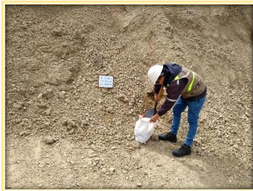
**Fotografía N° 03:** Selección de la muestra N°02 -25 kilos -Cantera km 39+842 PE .3SC Acceso A3 km Tayacaja
