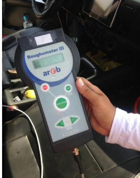
El rugosímetro III está diseñado para prever datos de rugosidad, pueden ser utilizados para comparar y analizar objetivamente cual carretera requiere reparación, y monitorear las tendencias de deterioro.
