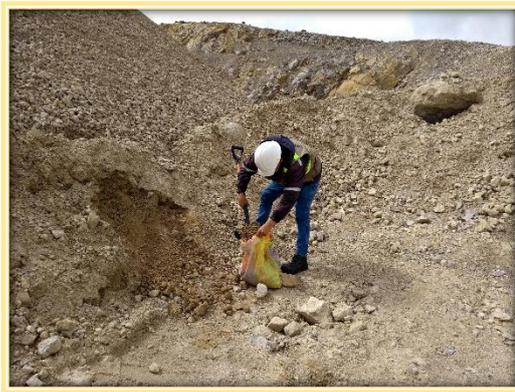
**Fotografía N° 04:** Selección de la muestra N°03 -25 kilos -Cantera km 39+842 PE .3SC Acceso A3 km Tayacaja
