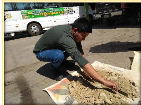
**Fotografía N° 02:** Cuarteo de material granular.
