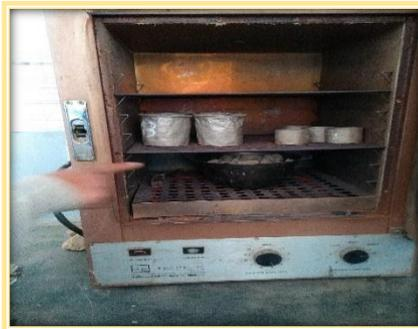
**Fotografía N° 01:** Horno de laboratorio de suelos.
