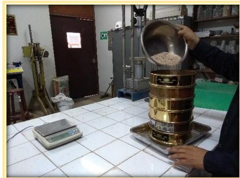
**Fotografía N° 06:** Análisis granulométrico para el lavado asfáltico.
