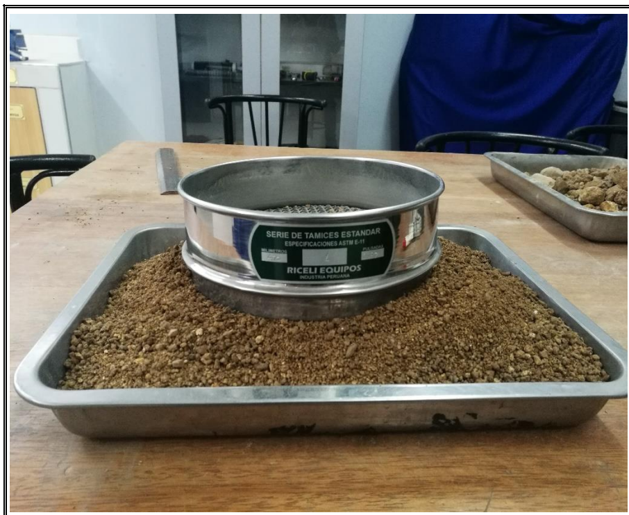
Fotografía N° 06 TAMIZADO EN LA MALLA N° 4, DE 6 KG PARA REALIZAR EL ENSAYO DE CBR.
