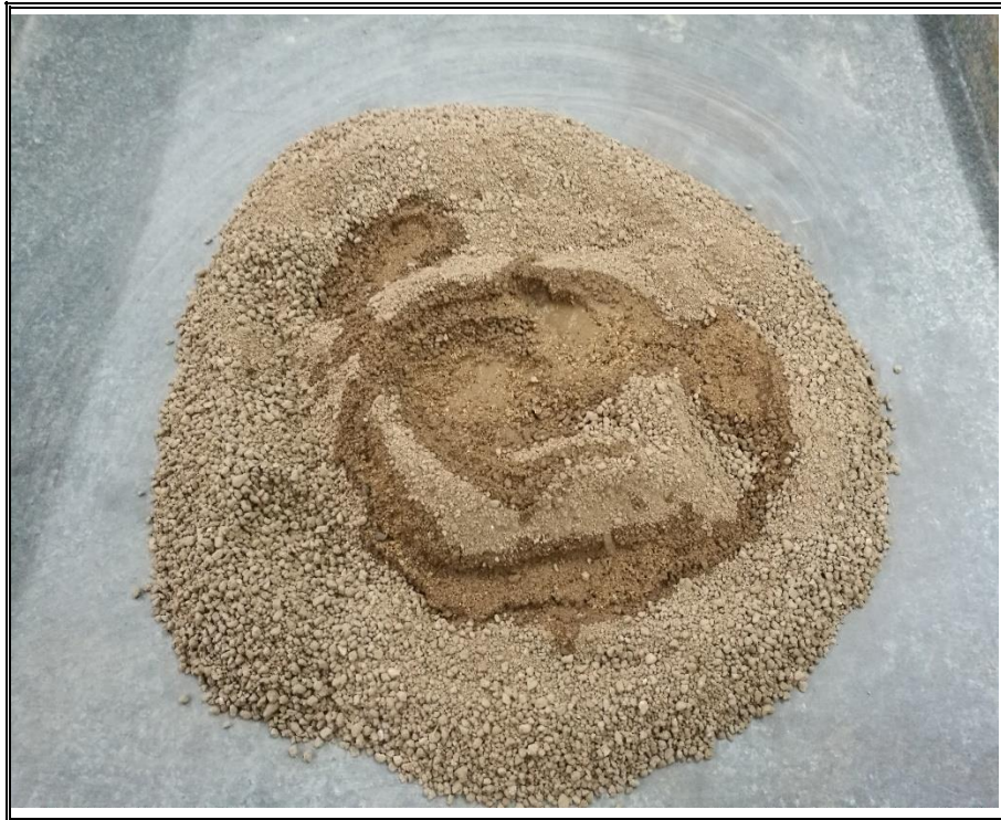
Fotografía N° 07 EL MEZCLADO DEL AGUA CON LA MUESTRA QUE SE REALIZÓ DE ACUERDO AL CONTENIDO DE HUMEDAD, PARA EL CBR.
