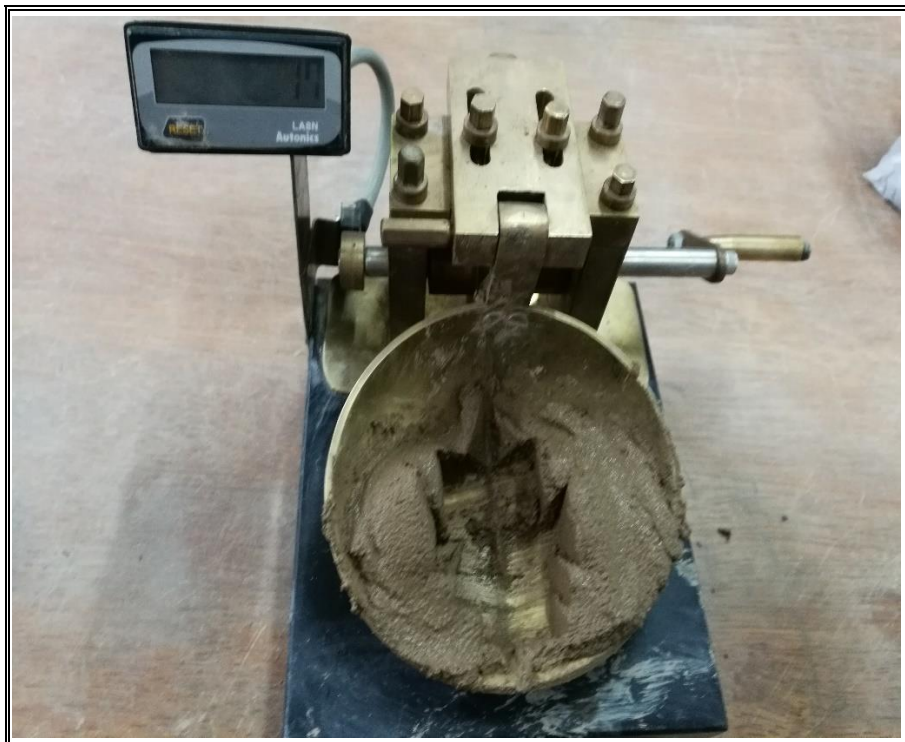
Fotografía N° 14 SE MEZCLA LA MUESTRA CON AGUA, PARA LUEGO REALIZAR LOS GOLPES EN LA COPA DE CAZA GRANDE, PARA EL LIMITE LIQUIDO.
