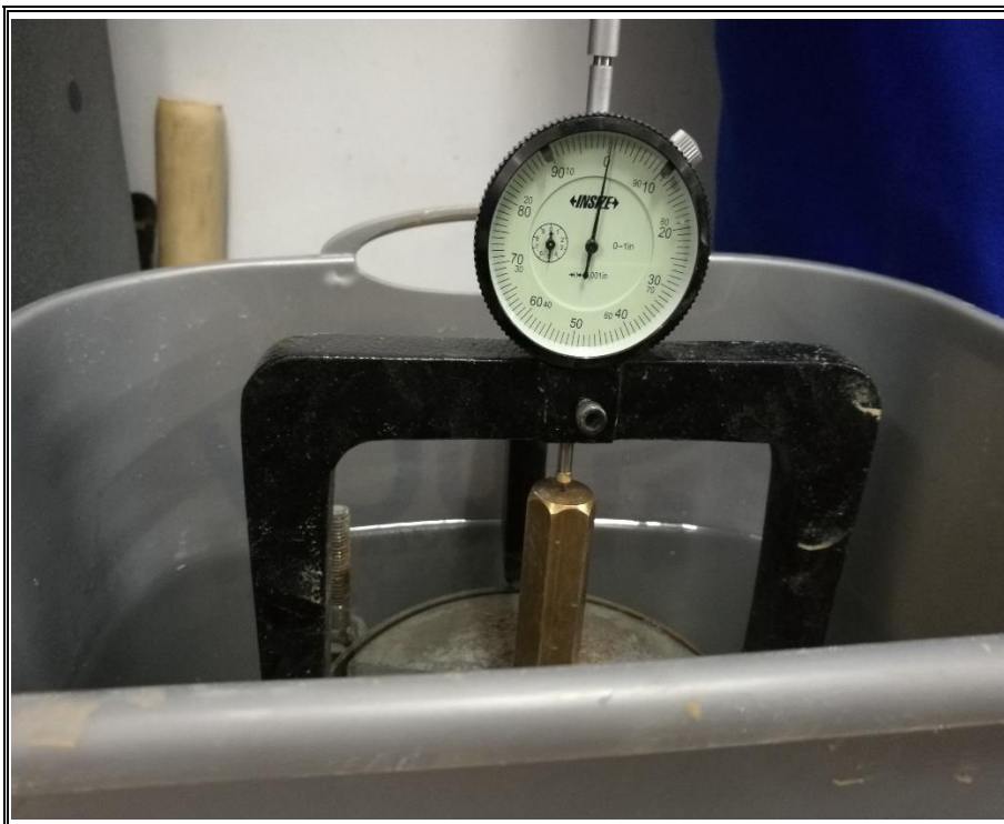
Fotografía N° 10 SE SUMERGE AL AGUA PARA VER LA SATURACIÓN DEL SUELO.
