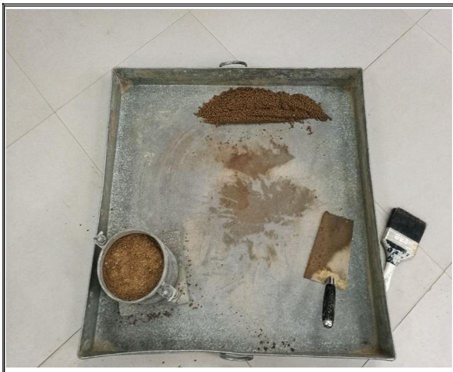
Fotografía N° 08 COMPACTADO DE LA MUESTRA DE 5 CAPAS, DE DIFERENTE GOLPES, QUE SON DE 10, 25 Y 56 DEL CBR.
