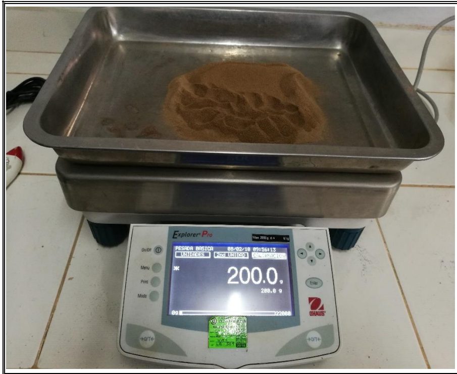
Fotografía N° 13 TAMIZADO DE LA MALLA N° 40 PARA EL ENSAYO DE LL – LP Y GRANULOMETRÍA.
