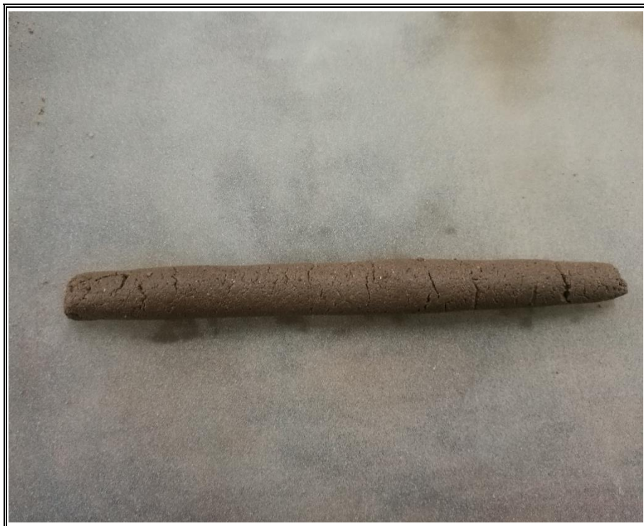
Fotografía N° 16 SE ROTULA LA MUESTRA HASTA QUE ESTA SE FISURE, PARA EL LIMITE PLÁSTICO, PARA LUEGO LLEVARLO AL HORNO.
