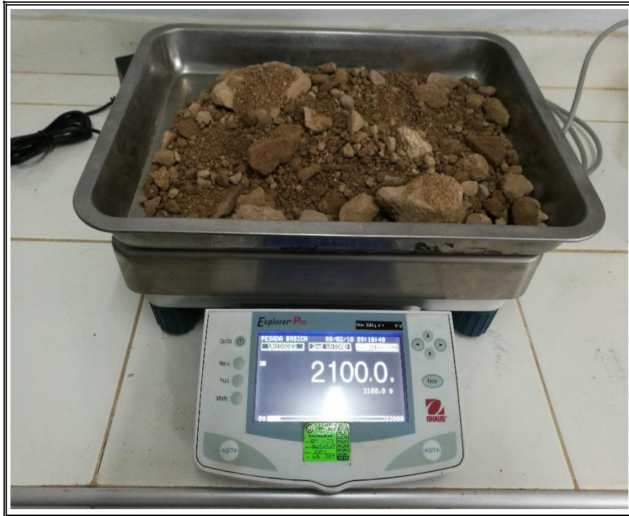
Fotografía N° 17 PARA EL ENSAYO DE GRANULOMETRÍA SE PESA 2100 GRAMOS.
