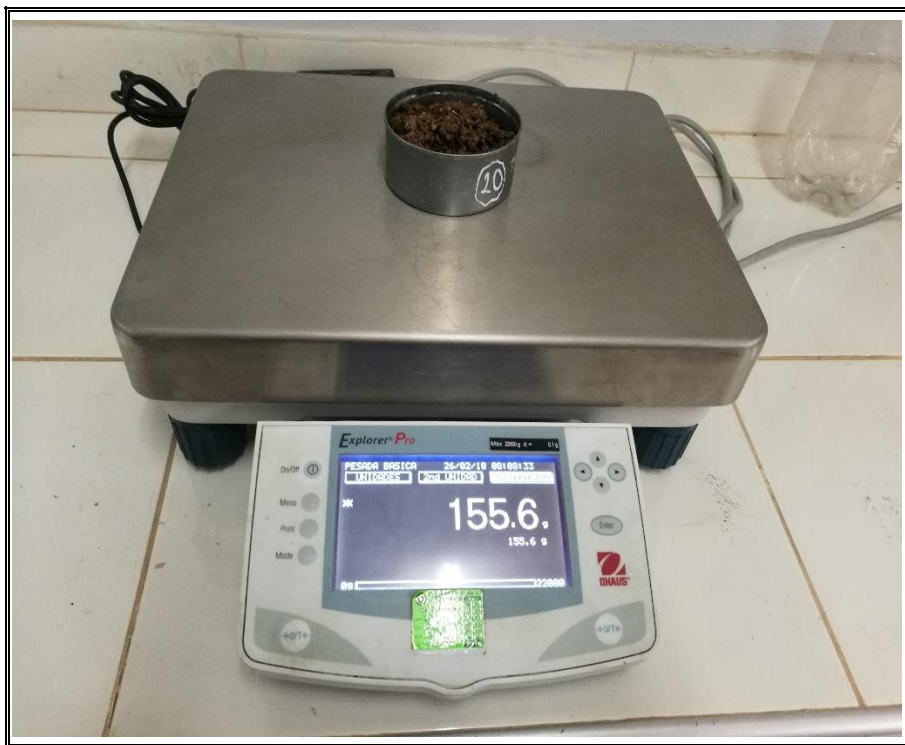
Fotografía N° 12 EXTRACCIÓN DE LA MUESTRA DEL CBR SATURADA, PARA CALCULAR EL CONTENIDO DE HUMEDAD.
