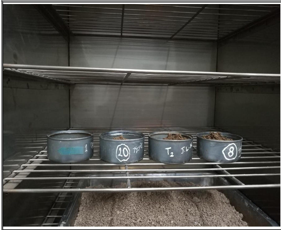
Fotografía N° 05 SECADO DE LAS MUESTRAS EXTRAÍDAS DEL COMPACTADO, PARA OBTENER EL CONTENIDO DE HUMEDAD.
