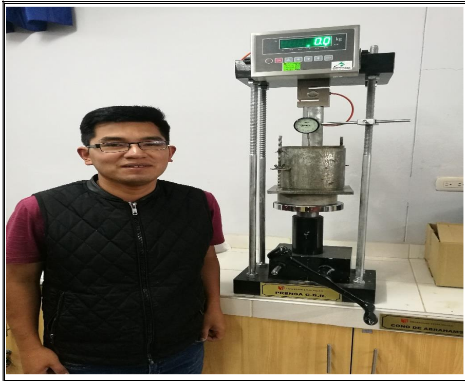
Fotografía N° 11 SE SACA DEL AGUA Y SE LLEVA A LA PRENSA CBR Y VER LA FUERZA DE PENETRACIÓN Y CUANTO AGUANTA EL SUELO.
