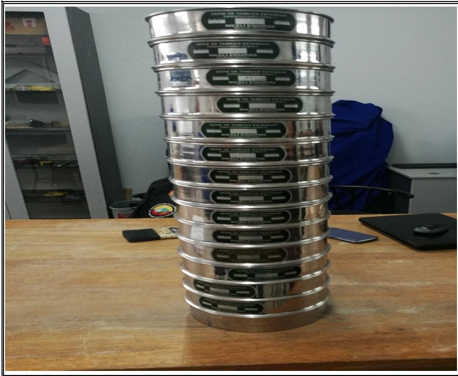
Fotografía N° 19 TAMIZAR EL MATERIAL DESPUÉS DE QUE HAYA SECADO EL MATERIAL EN EL HORNO.
