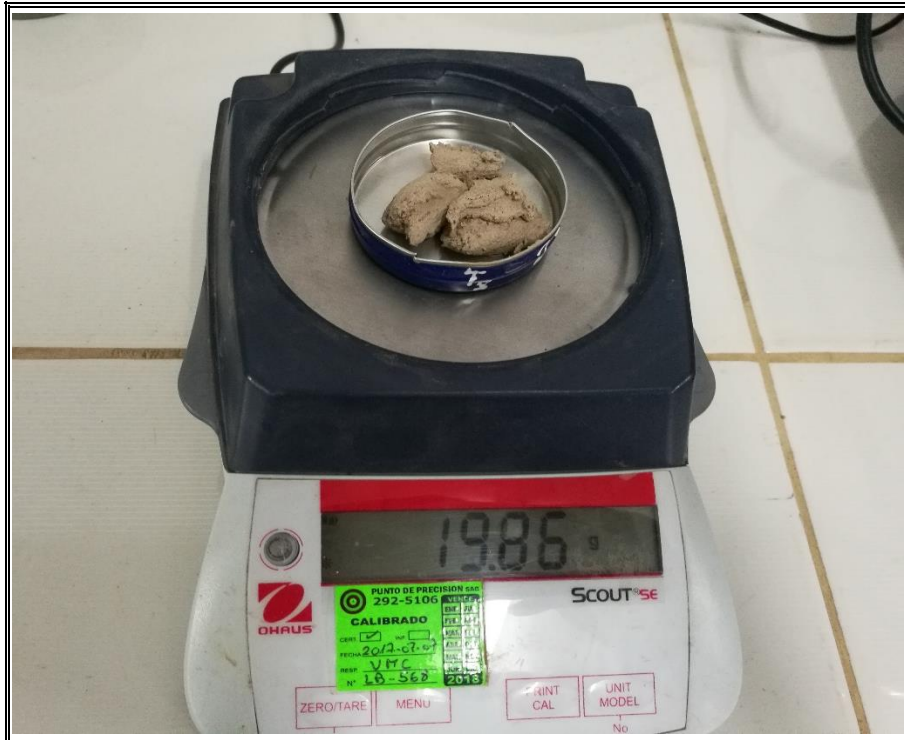
Fotografía N° 15 SE EXTRAE UN POCO DE LA MUESTRA, PARA LUEGO METERLO AL HORNO.
