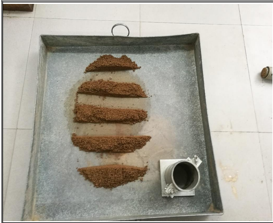
Fotografía N° 03 DIVISIÓN DE LA MUESTRA EN 5 PARTES, PARA SU COMPACTADO DE 25 GOLPES CADA CAPA.
