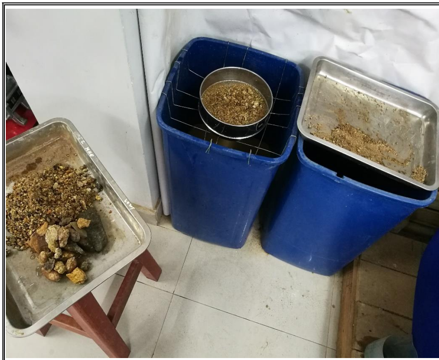
Fotografía N° 18 SE LAVA LA MUESTRA DE 2100 GRAMOS EN LA MALLA N° 200 Y LLEVARLO AL HORNO.
