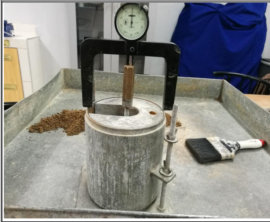
Fotografía N° 09 SE COLOCAN LAS PESAS SIMULANDO LAS CAPAS DEL PAVIMENTADO.
