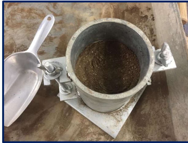
Fotografía 17: Compactación del Proctor modificado.
