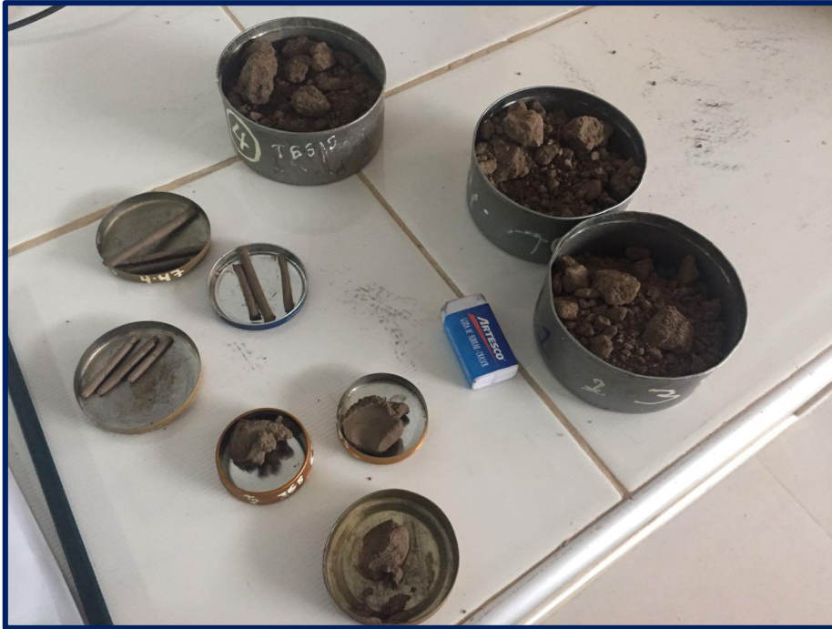
Fotografía 15: Muestras de contenido de humedad, plasticidad y límites.
