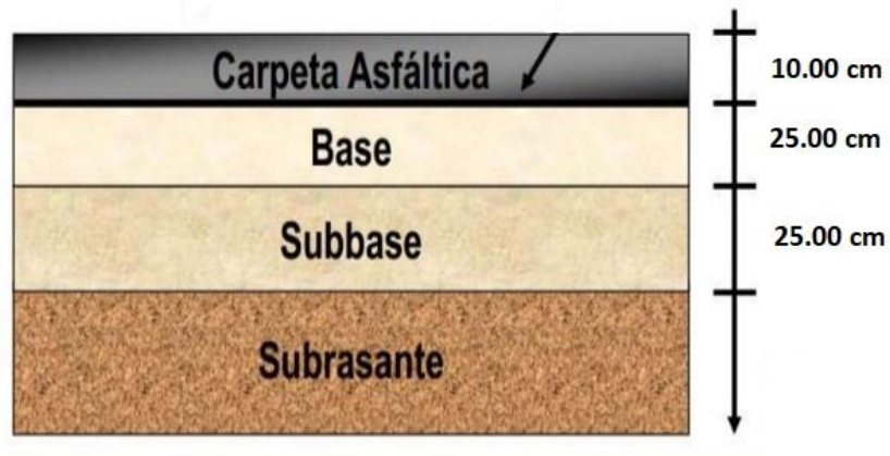
Estructura del Pavimento.
