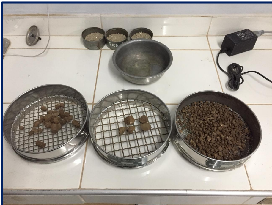
Fotografía 14: Muestras de las piedras que quedaron en las diferentes mallas.
