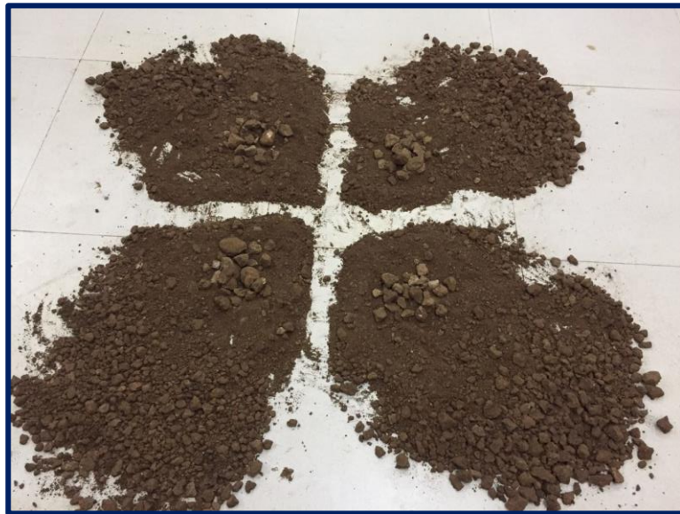
Fotografía 12: Cuarteo para realizar los ensayos de suelos
