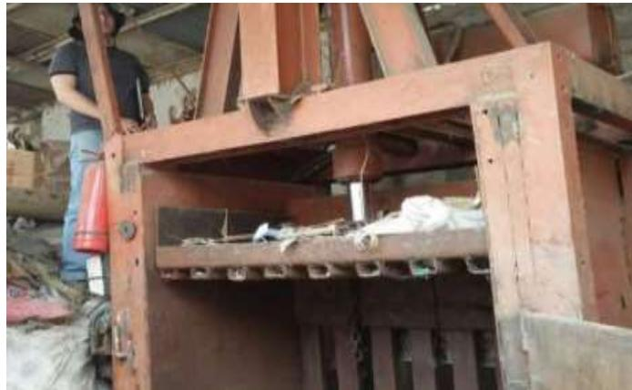
**Figura 1.** *Compactadora vertical*
