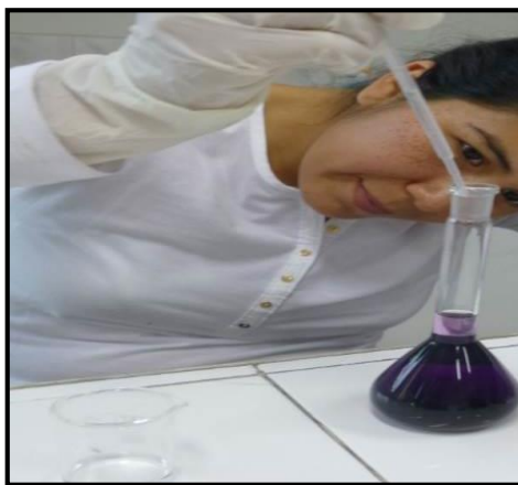
Figura 10. Preparación para obtención de la recta de calibración
