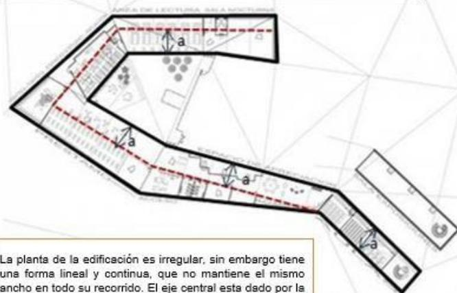
La planta de la edificación es irregular, sin embargo tiene una forma lineal y continua, que no mantiene el mismo ancho en todo su recorrido. El eje central esta dado por la organización de la estructura que mantiene una distancia igual en todo su largo hacia la fachada exterior. La forma en planta permite tener un ambiente publico acogido entre los volúmenes.
