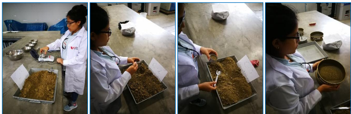
Figura 3.7. Ensayo de Contenido de Humedad
