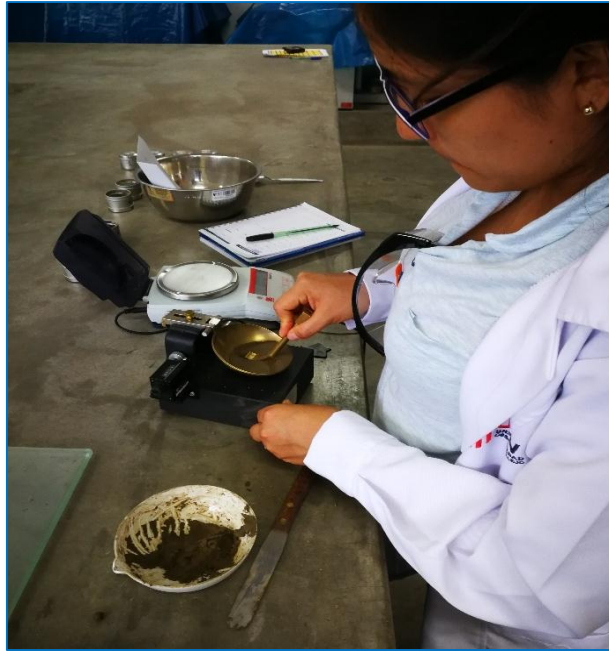
Figura 3.8. Ensayo de Límites de Consistencia
