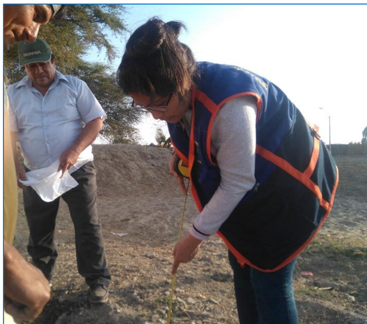
Figura 3.4. Excavación a 1.50 m para extracción de muestra
