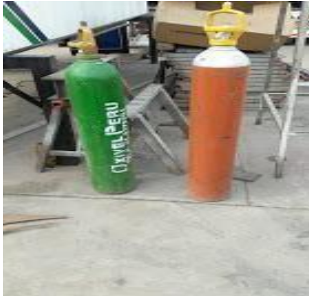
FIGURA N° 26 – BALONES DE OXICORTE ALMACENADOS INADECUADAMENTE
