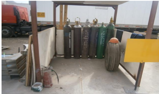
FIGURA N° 27 – BALONES DE OXICORTE ALMACENADOS ADECUADAMENTE
