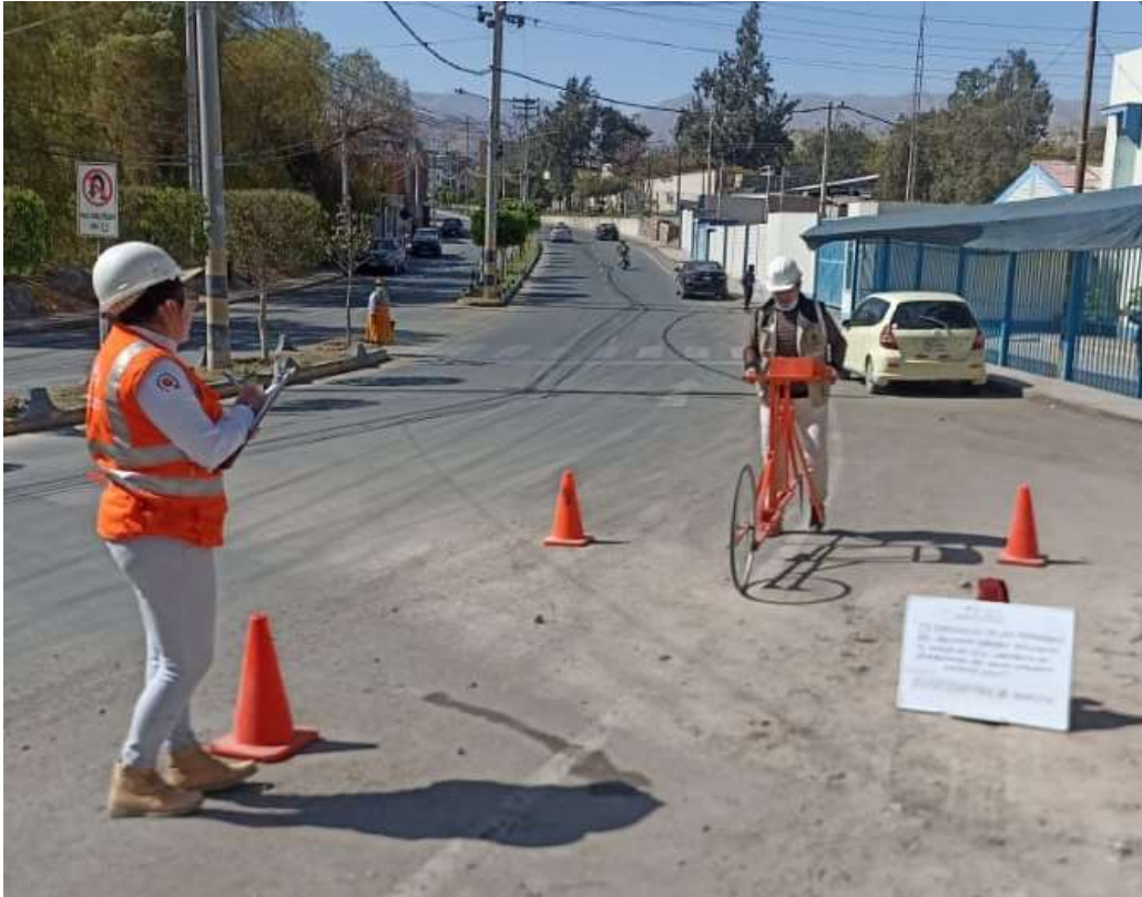
Figura N°14. Ensayo de rugosidad mediante el Método de Merlín.
