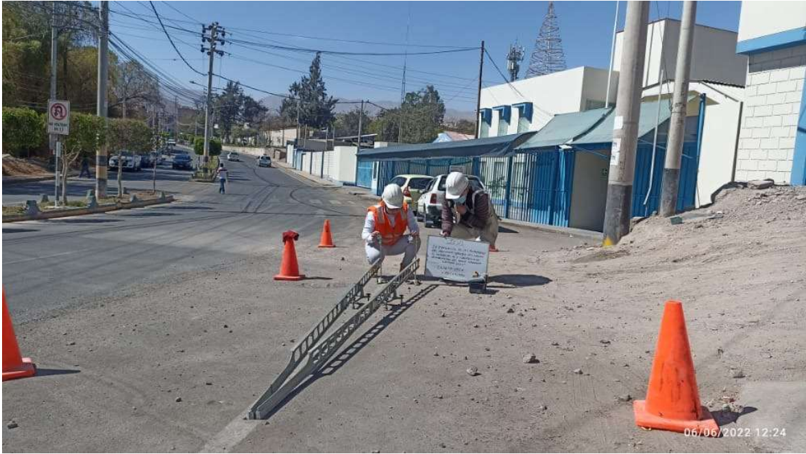
Figura N°13. Ensayo Viga Benkelman evaluación de la deflexión del pavimento.
