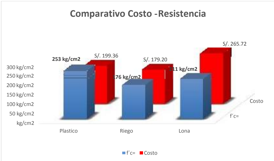
Figura 7: Gráfico comparativo de resistencia a la compresión ante el costo unitario del Curado.
