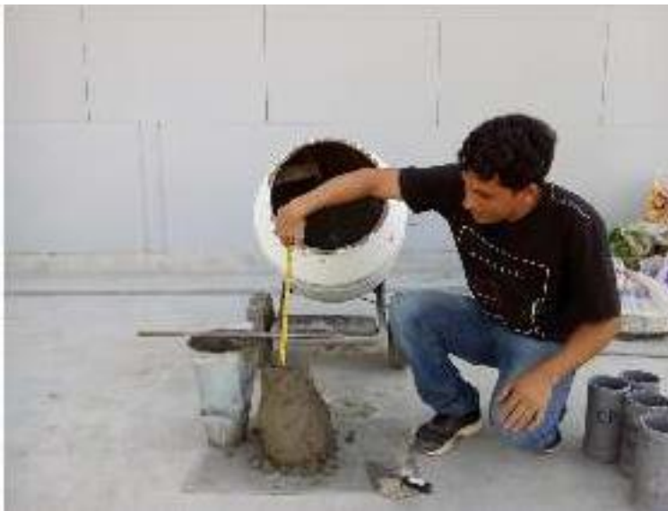
Figura 19: Medida del Slump
