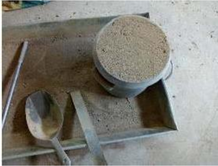
Figura 10: Ensayo de densidad de Agregado fino
