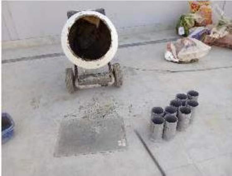
Figura 18: Trompo para elaboración de probetas patrón en laboratorio
