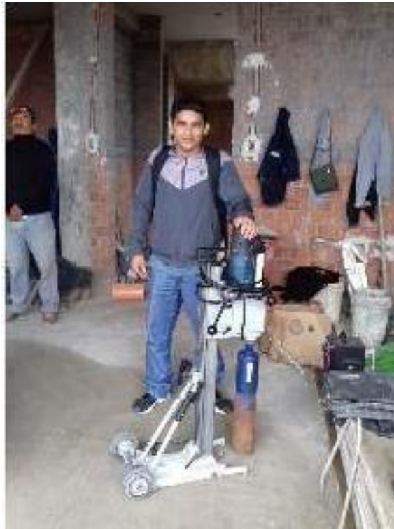
Figura 21: Maquina Diamantina extractora de Núcleos de Concreto
