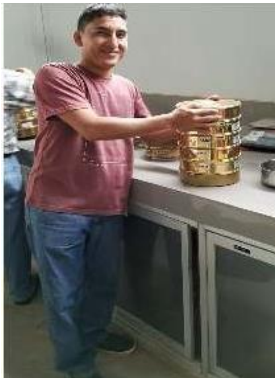
Figura 9: Realizando el tamizaje para obtener la curva granulométrica del agregado grueso
