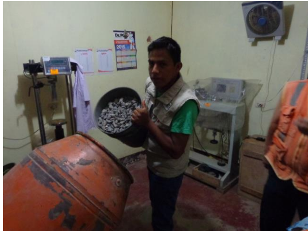
PONIENDO EL AGREGADO GRUESO EN LA MEZCLADORA PARA HACER LAS PROBETAS
