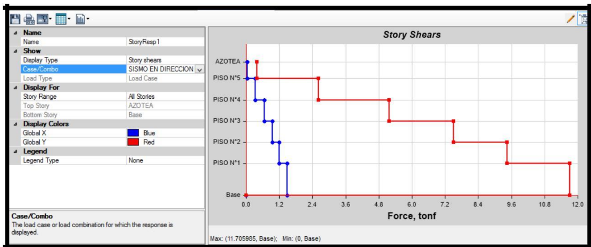
Figura N°69: Cortante máx. 11.70 ton en la base en sismo en dirección en Y de Albañilería Confinada con viga postensada.
