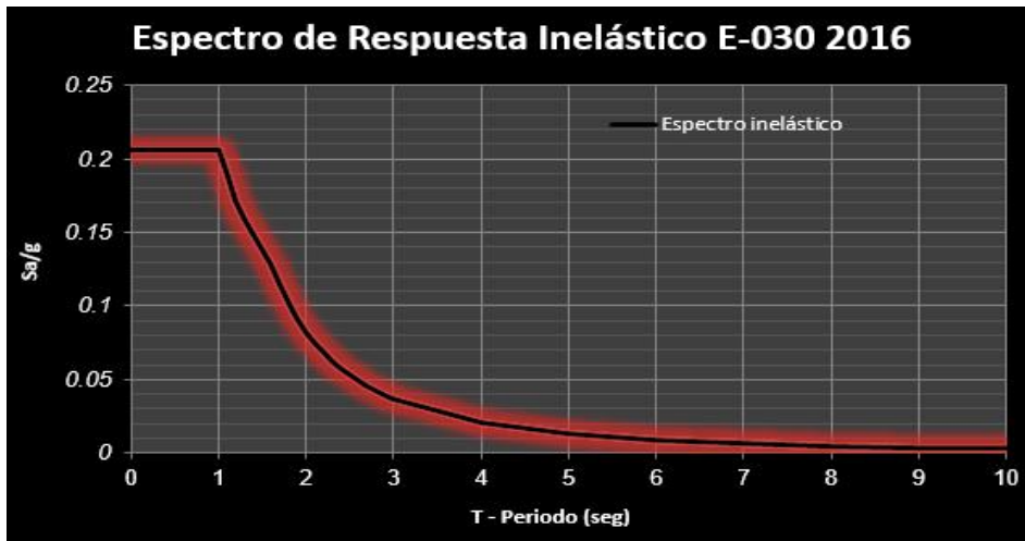
Figura N°26: Espectro de Respuesta Inelástico de Albañilería Confinada.
