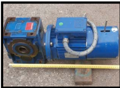
Figura 25 motorreductor para mover extrusora en forma eléctrica .
