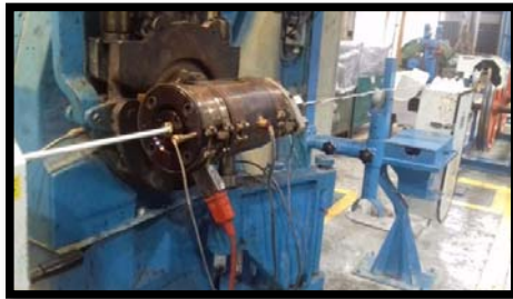
Figura 18 Forrado externo de cable eléctrico.
