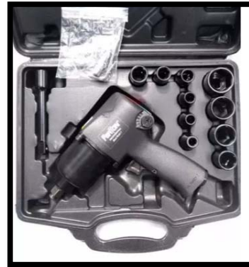
Figura 20 equipo neumático para ajuste de pernos de bronce
