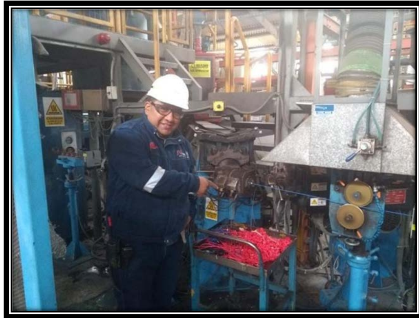
Gráfico 3 Máquina iniciando después de la purga y cambio de color.
