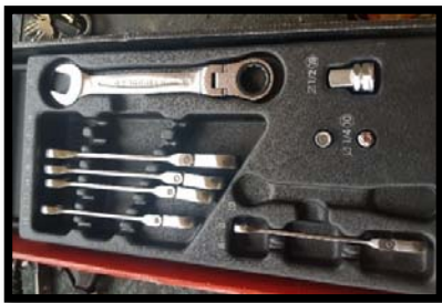
Figura 23 juego de llaves Rachell para reducir tiempo de ajuste espacio reducido
