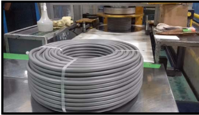
Figura 19 Conductor eléctrico enrollado para pruebas.
