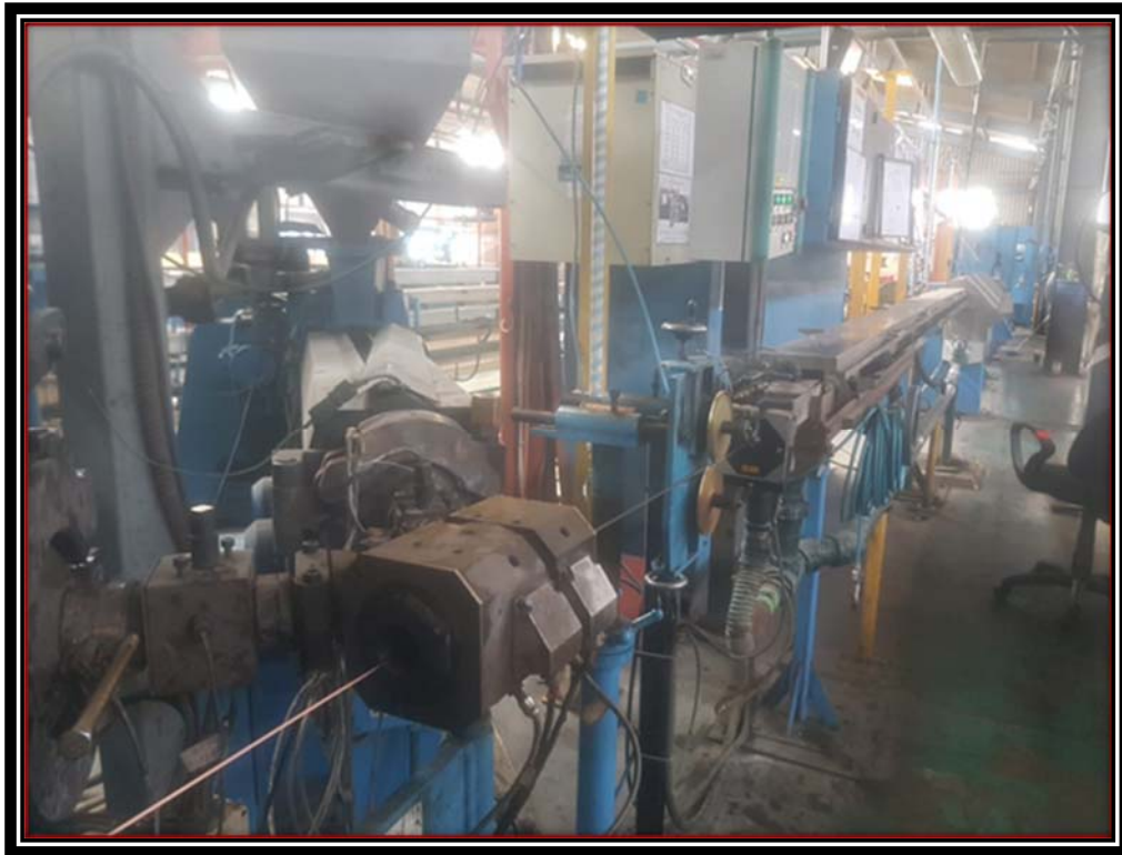
Gráfico 4 Maquina en proceso cable 14 AWG velocidad 700m/m.
