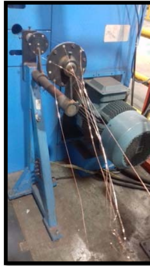
Figura 15 formador de entorchado
